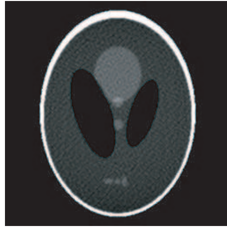
FIG. 2.9. Reconstruction du fantôme de Shepp-Logan par rétroprojection filtrée.
