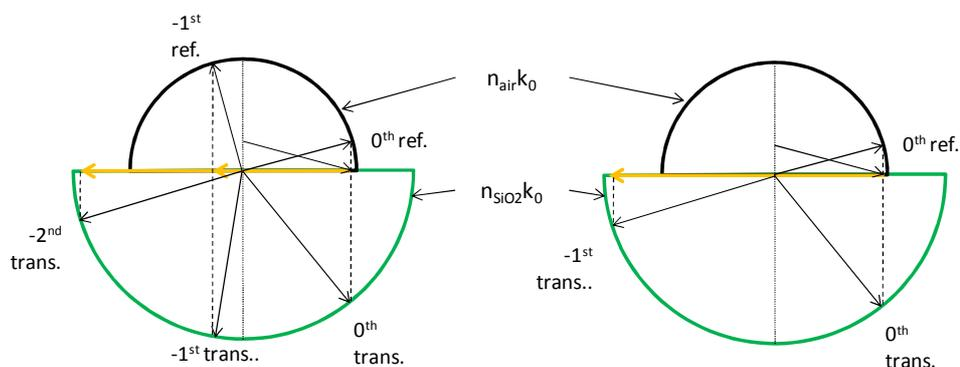
Figure 5-21: Diagramme des  $k$  représentant la direction de propagation des ordres de diffraction dans l'air (demi-cercle noir) et dans le substrat en silice (demi-cercle vert) quand le réseau est éclairé à la longueur d'onde  $\lambda=244$  nm. Gauche : si le réseau a une période égale à 200 nm ; Droite : si le réseau a une période égale à 100 nm.
