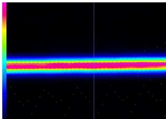
Figure 4-26: Capture d'écran obtenue avec l'analyseur de faisceau de la répartition d'intensité de la ligne de lumière générée à l'aide de lentilles cylindriques divergentes.
