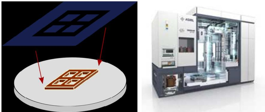
Figure 2-11 : Fonctionnement du principe de projection. Droite: Machine de projection ASML<sup>5</sup>.
