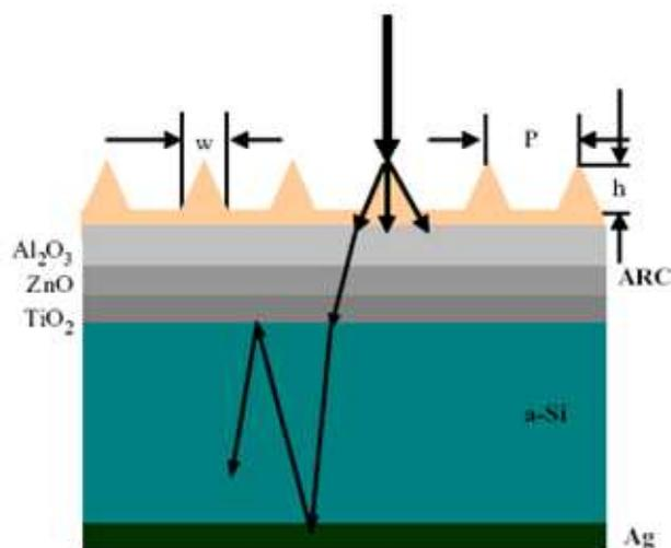
Figure 1-26: Vue schématique de la structure multicouche proposée [21].
