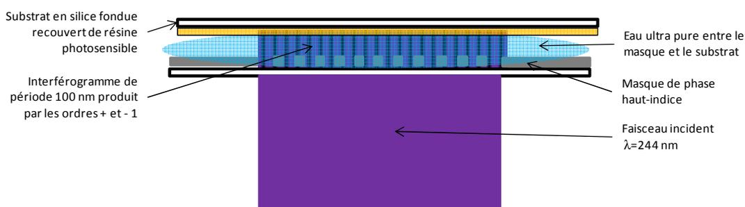
Figure 5-19: Schéma représentant la mise en œuvre du masque de phase pour l'écriture de réseau de période 100 nm.
