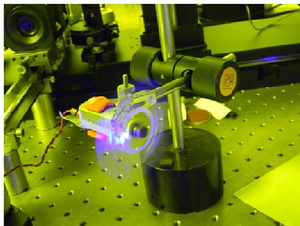
Figure 4-40: Photo du montage montrant le DOE circulaire sur le moteur.
