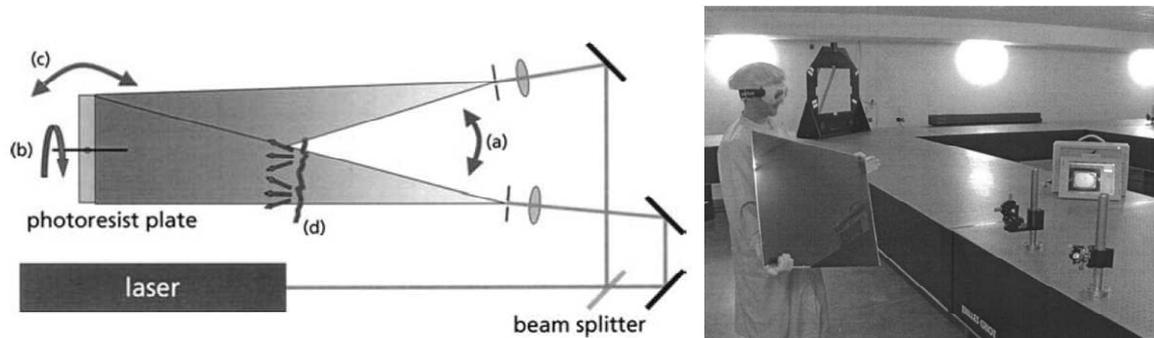
Figure 2-3: Schéma et image d'un dispositif de lithographie interférentielle de l'ISE. LE profil obtenu dans la résine dépend des paramètres d'expositions : (a) angle entre les faisceaux (b) double exposition avec rotation du substrat (c) angles d'incidences asymétriques (d) utilisation d'un diffuseur.
