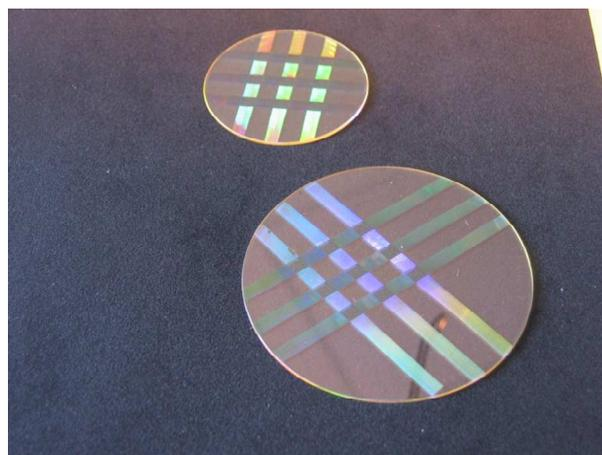
Figure 4-14: Photo de réseaux de diffraction 2D de période 650 nm. Les réseaux 2D se trouvent à l'intersection des pistes.
