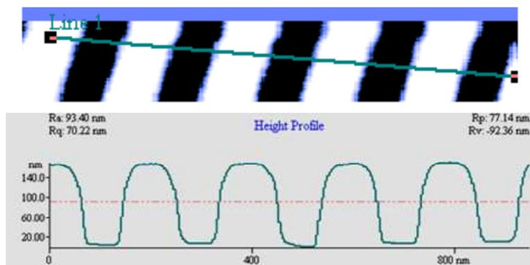
Figure 5-13: Scan AFM du masque de phase LPN 1.
