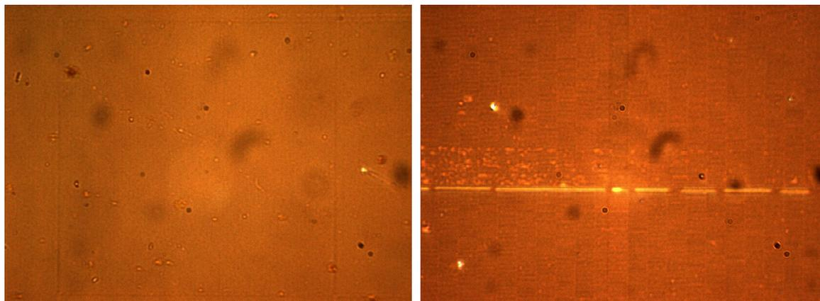
Figure 5-12: Images prises au microscope optique du masque de phase LPN 1 mettant en évidence les erreurs de *stitching*. Gauche : grossie 100 fois, les dimensions du carré sont de 320 µm de côté. Droite : Grossie 150 fois, la largeur des bandes est de 4,7 µm.
