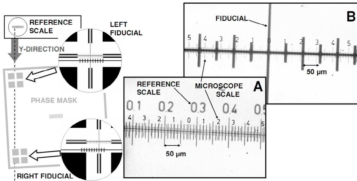
Figure 4-8: Système d'ajustement du lacet : Les croix d'alignement sont alignées sur une règle de référence fixée au banc. La sous-figure A montre une image de la règle de référence fixée au banc (distance entre deux traits =  $10\ \mu\text{m}$ ). La sous-figure B montre la croix d'alignement vue à travers l'objectif de microscope (la distance entre deux traits est de  $50\ \mu\text{m}$ ) [58].
