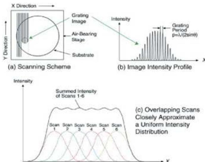
Figure 2-6: Procédé de chevauchement des faisceaux du Nanoruler.
