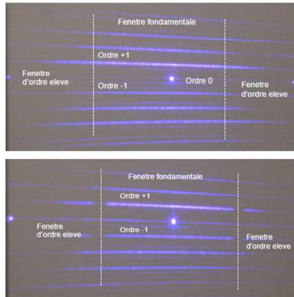
Figure 4-37: Photos des lignes générées par le DOE de type 4 niveaux *off-axis*. Haut: Avec la ligne de la fenêtre fondamentale qui touche celle des fenêtres des ordres supérieurs. Bas : Cas où la ligne fondamentale est séparée de celle des ordres supérieurs.
