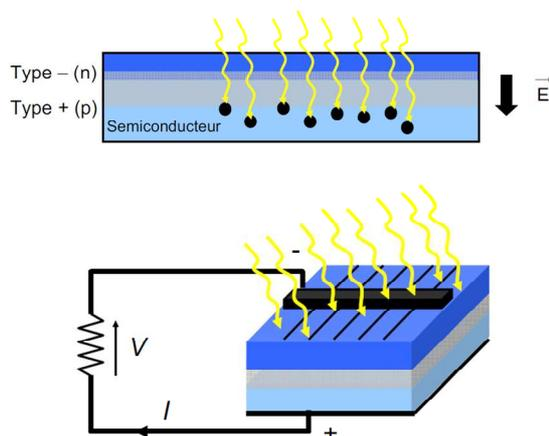
Figure 1-22: Schéma de principe du fonctionnement d'une cellule photovoltaïque, la tension générée dépend du matériau semi conducteur utilisé (1,12 V pour le silicium cristallin) l'intensité dépend de la surface de la cellule (10-40 mA/cm<sup>2</sup>)
