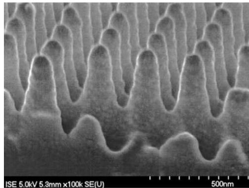
Figure 1-19: Image MEB d'une structuration de surface 2D créant un gradient d'indice. Source ISE.
