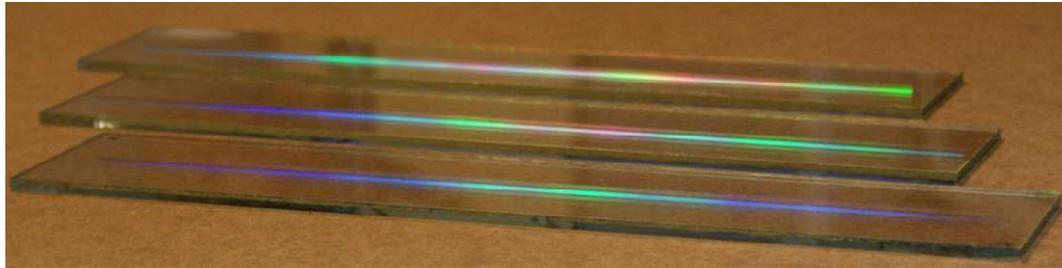
Figure 4-12: Photos de réseaux de diffraction de dimensions  $3 \times 300 \text{ mm}^2$  écrits par la technique d'écriture au vol sans modulation.
