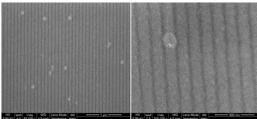
Figure 5-23: Images prises au MEB-FEG de réseaux de période 100 nm.
