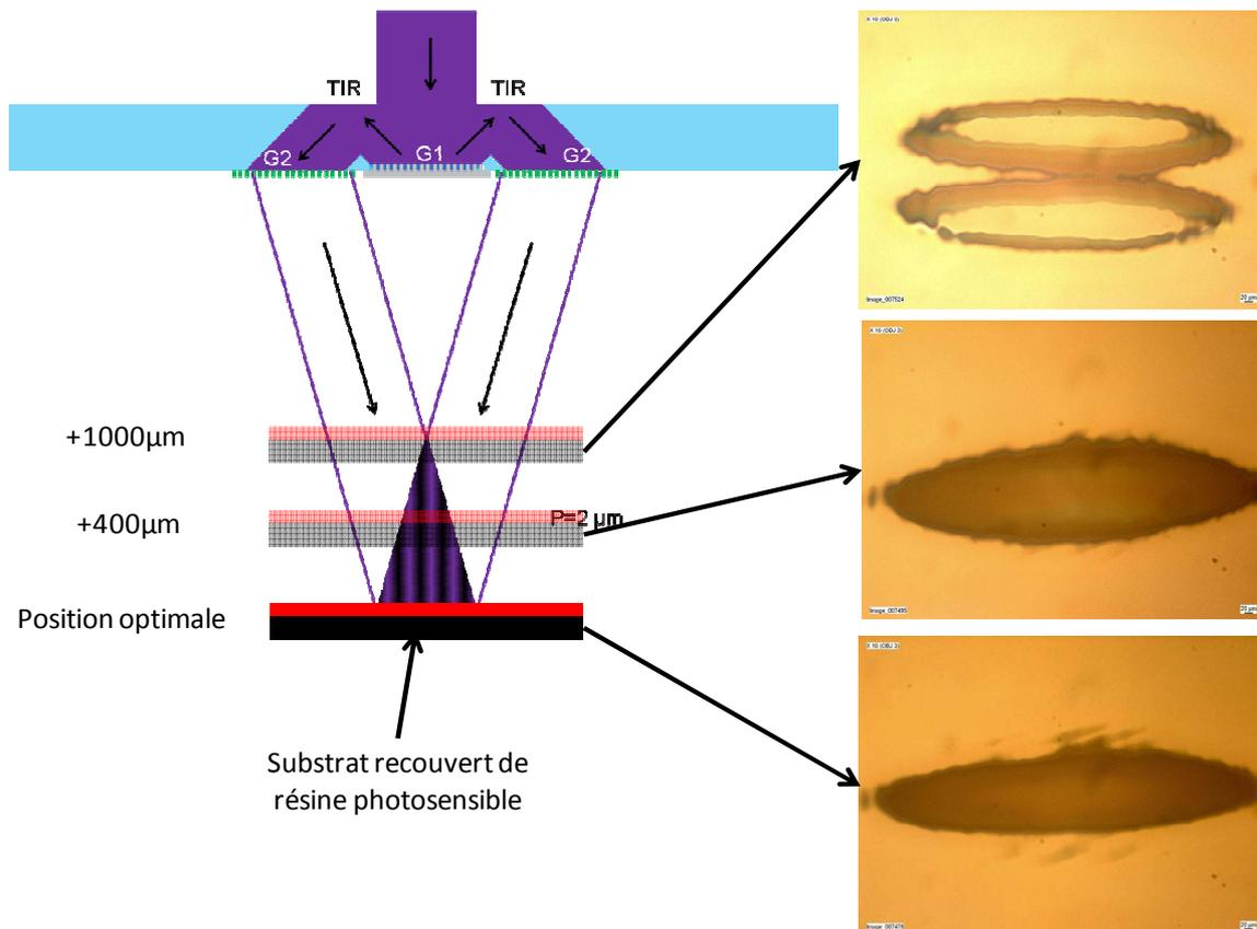
Figure 4-6: Schéma de la procédure permettant de trouver la distance optimale substrat-masque et images prises au microscope optique des réseaux insolés statiquement à ces positions. Haut: à +1000  $\mu\text{m}$  de la hauteur optimale. Centre: à + 400  $\mu\text{m}$  de la hauteur optimale. Bas: à la hauteur optimale.
