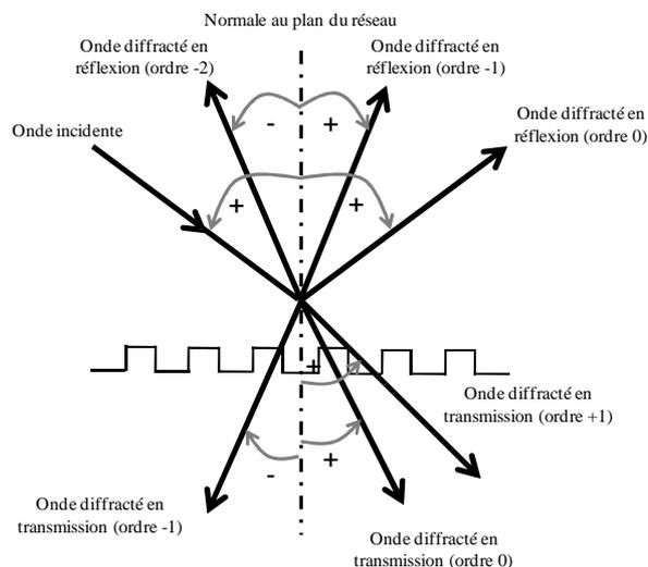
Figure 1-8: Convention de signe adoptée pour les angles des ordres de diffraction par rapport à la normale au réseau.
