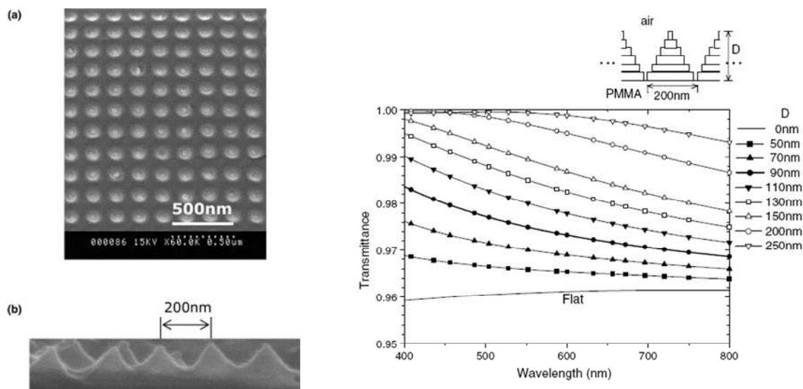
Figure 1-25: Exemple de nanostructures sur une cellule de silicium pour l'application *solar light trapping*. Gauche : Images MEB des structures sub-longueur d'onde a) vue de dessus ; b) vue de coté. Droite : transmittance calculée en fonction de la profondeur des structures [20].
