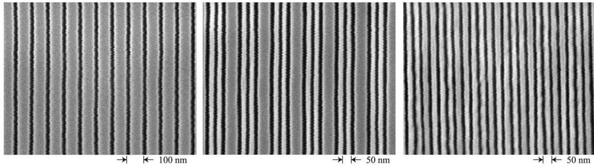
Figure 2-18: à gauche, image MEB d'un réseau de période 100 nm fabriqué en superposant deux interférogammes de période 200 nm déphasé de  $\pi$ . Au centre image MEB de motifs réalisés après trois superpositions de l'interférogramme de période 200 nm. A gauche : Réseau de période 50 nm résultat de quatre superpositions.
