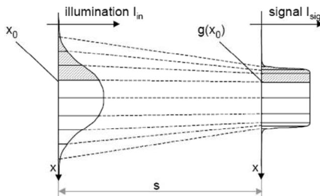
Figure 4-43: Schéma de fonctionnement du *beam-shaper* réfractif
