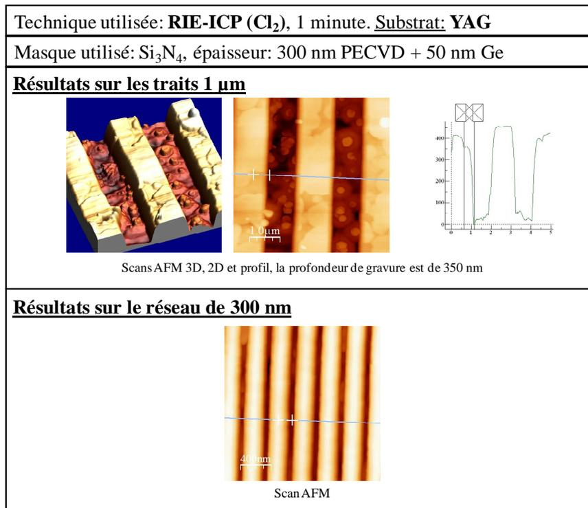
Figure 3-17: Résultats des essais de gravure du LuAG classés en fonction de la technique utilisée : IBE, RIE-CCP (SiCl<sub>4</sub>) et RIE ICP (Cl<sub>2</sub>).
