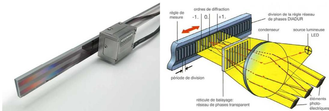
Figure 1-18: Photo d'un capteur de déplacement utilisant une règle optique (gauche) et schéma de fonctionnement (droite). Source Heidenhain, [13].
