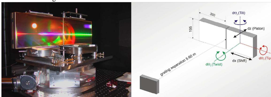
Figure 1-17: à gauche : photo d'un réseau de grande dimension obtenu par *tiling* pour la compression d'impulsion laser utilisé par l'équipe POLARIS institute for optics and quantum electronics ; Friedrich Schiller Institute, Iéna ; Allemagne [12]. A droite: les dimensions du réseau et les degrés de libertés pour l'alignement.
