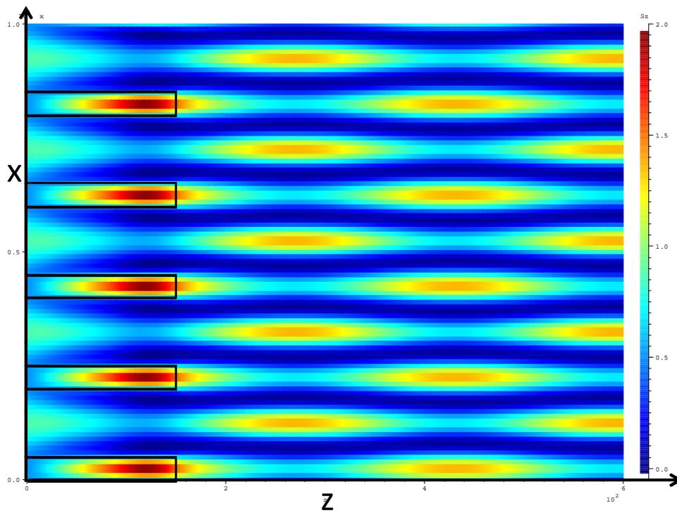
Figure 5-7: Evolution de l'intensité de l'interférogramme sous le masque de phase. Représentation en échelle de couleur. Les rectangles noirs à gauche de la figure représentent les plots en  $\text{Si}_3\text{N}_4$ .
