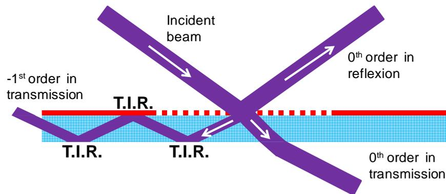
Figure 5-22: Représentation des ordres de diffractions générés par un réseau de période 100 nm en résine sur un substrat en silice fondue, éclairé par un faisceau laser de longueur d'onde  $\lambda=244$  nm. On peut voir l'ordre de diffraction -1 en transmission piégé dans le substrat.
