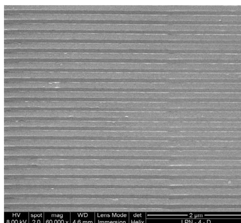
Figure 5-14: Image MEB prise en plongée du masque de phase LPN 4-D prise sur une zone de raccordement entre deux champs. Le raccordement de champ est difficilement distinguable tant sa diminution a été optimisée.
