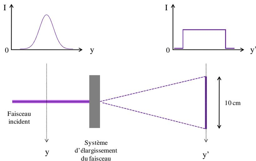
Figure 4-24: Schéma de principe de l'élargissement du faisceau.
