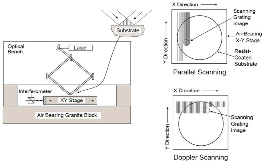
Figure 2-5: Schéma de principe du Nanoruler dans lequel un substrat est balayé sous une figure d'interférence.
