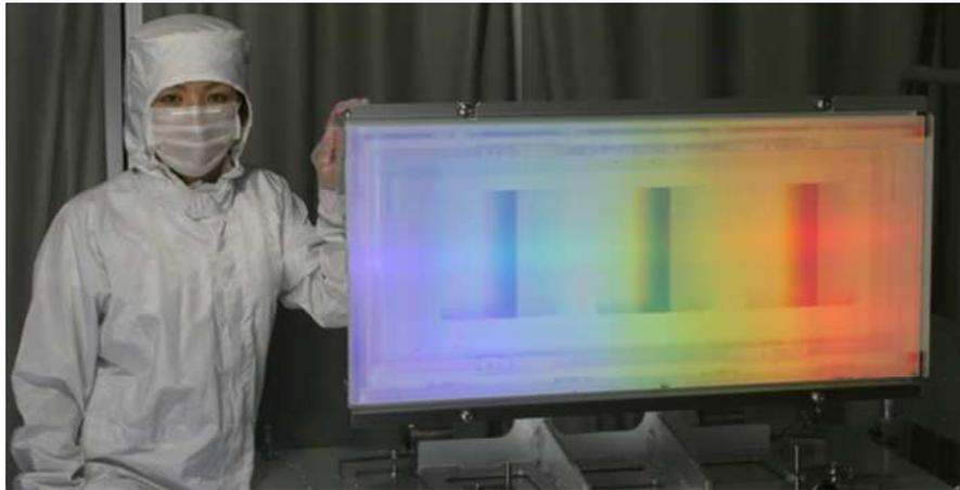
Figure 2-8: Un réseau multicouche MLD réalisé à l'aide de la technique de SBIL pour l'*Institute for Laser Engineering* de l'université d'Osaka au Japon. Les dimensions du réseau sont de 91cm par 42 cm [26].
