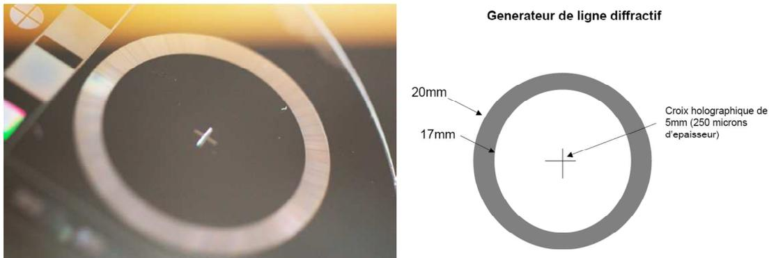
Figure 4-39: Image et schéma du DOE circulaire.
