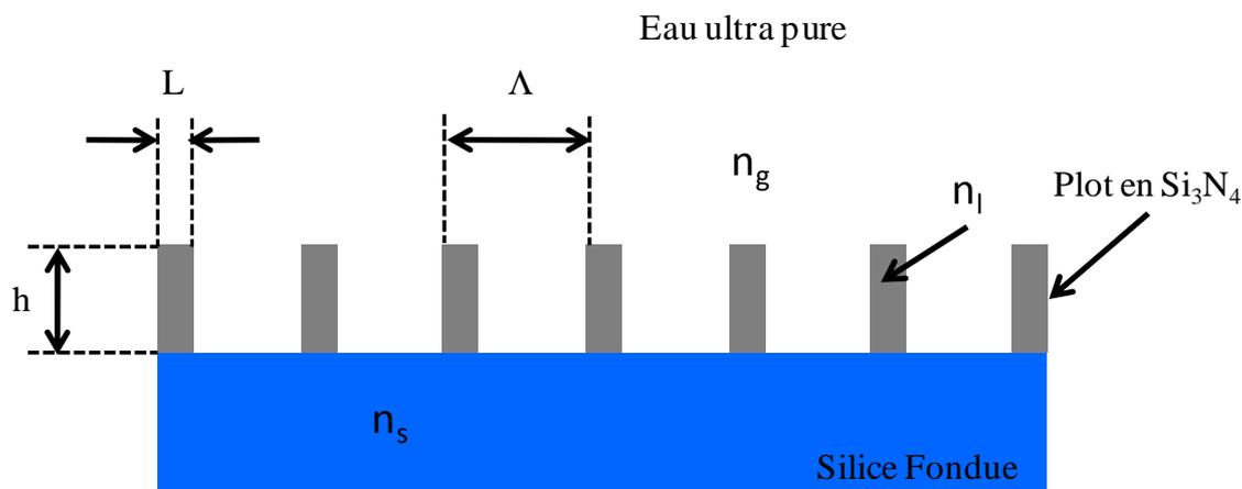
Figure 5-1: Schéma de la structure du masque de phase haut-indice.
