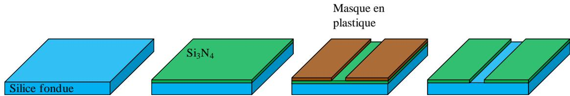
Figure 4-18: Représentation schématique du dépôt de la couche de  $\text{Si}_3\text{N}_4$  et de la réalisation de l'ouverture pour le réseau central.
