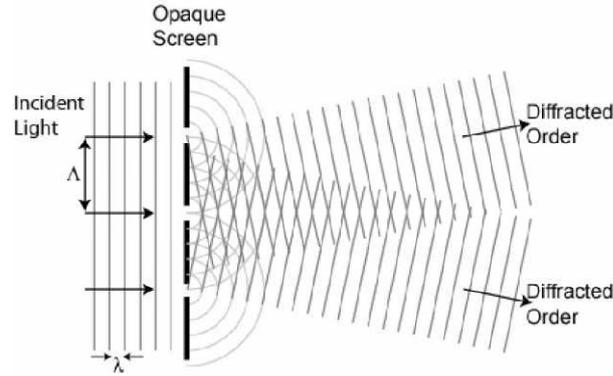
Figure 1-6: représentation schématique de l'interaction entre une onde plane monochromatique de longueur d'onde  $\lambda$  et un réseau de période  $\Lambda$ . Chaque fente du réseau réémet de la lumière qui interfère avec celles réémises par les autres fentes.
