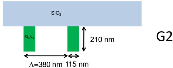
Figure 3-9: Paramètres et schéma des réseaux G1 et G2 constituant un masque de phase monolithique avec les réseaux situés de part et d'autre du substrat. Haut: G1. Bas: G2.
