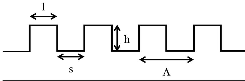
Figure 1-1: Réseau binaire, et ses paramètres associés
