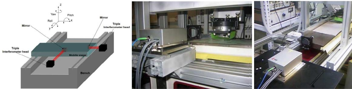
Figure 4-5: Mesure interférométrique des performances mécaniques du banc. Gauche: Schéma du montage. Centre: Photo prise lors des mesures dans la direction perpendiculaire au déplacement. Droite: Mesures du lacet et du tangage.
