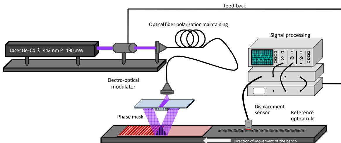
Figure 4-46: Schéma de principe de l'écriture au vol.
