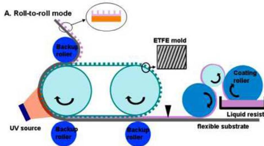
Figure 2-12: Principe de fonctionnement du *roll to roll* [28].
