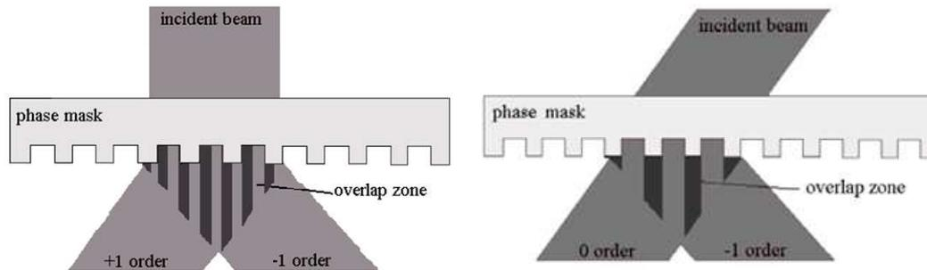
Figure 2-27: réseaux de diffraction utilisés comme masque de phase.
