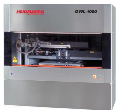
Figure 2-20: Photo d'une machine d'écriture laser; Heidelberg DWL 4000. On distingue sur l'image la table sur laquelle est posé le substrat ainsi que le laser.
