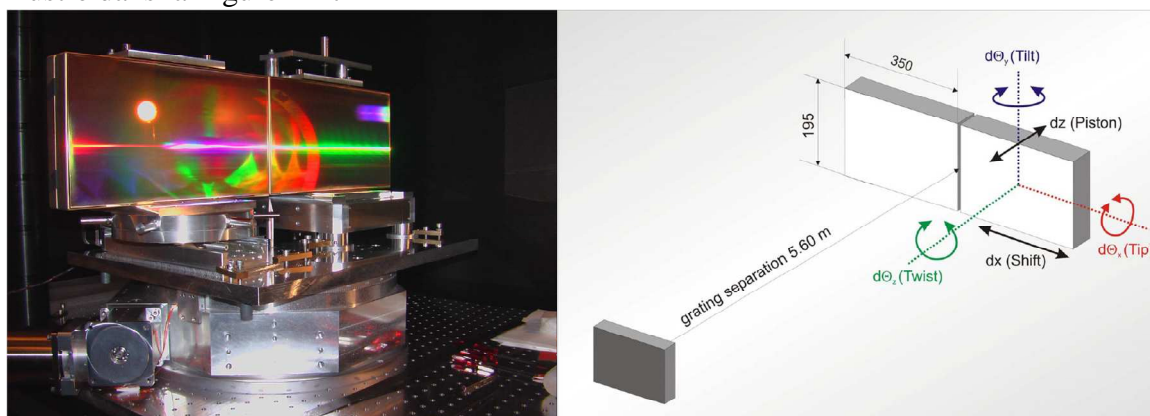
Figure 1-17: à gauche : photo d'un réseau de grande dimension obtenu par tiling pour la compression d'impulsion laser utilisé par l'équipe POLARIS institute for optics and quantum electronics ; Friedrich Schiller Institute, Iéna ; Allemagne [12]. A droite: les dimensions du réseau et les degrés de libertés pour l'alignement.
