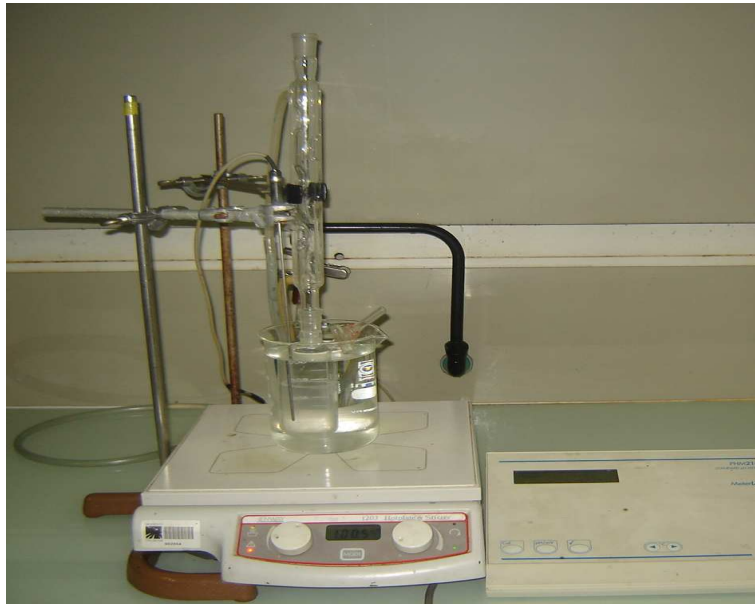
Figure II.6: Montage réactionnel avec plaque chauffante et dispositif de refroidissement à eau.
