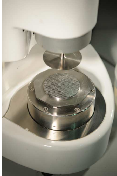
FIGURE 8.3 – Rhéomètre avec dispositif plan/plan (photo H. Raguet).
