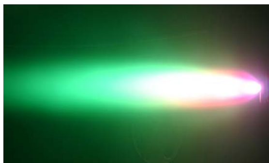
I=600, 40 NI/min Ar, 5 H2 avec Cu
