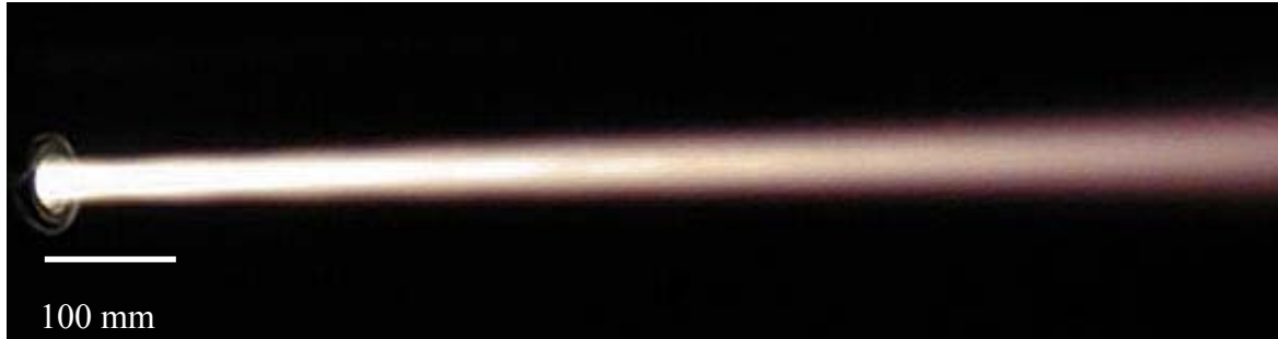
a) P=5 mbar, Ar 40 NI/min, H2 5 NI/min, I=600A (buse Laval)
