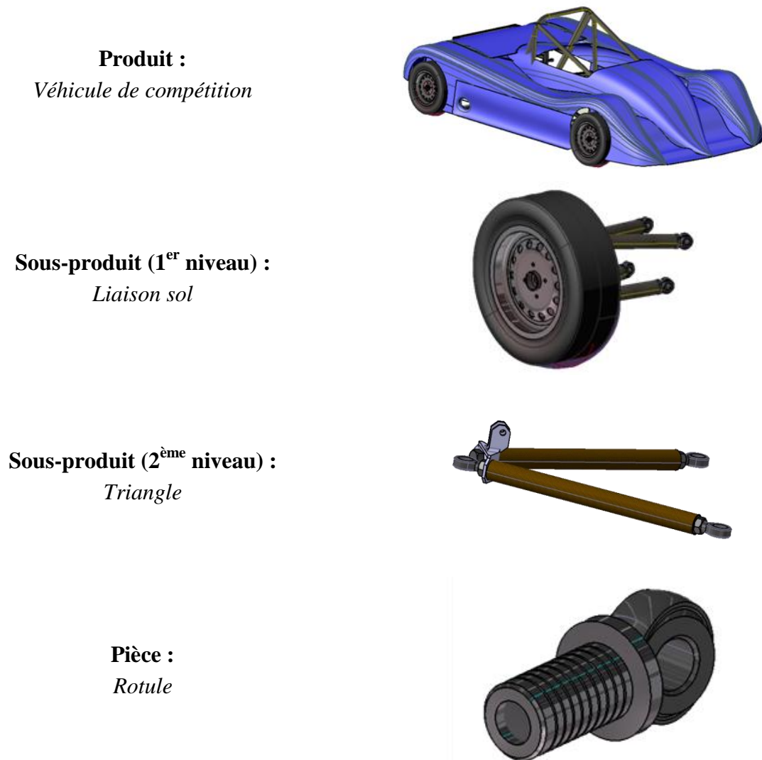
Figure 38 : Exemple de décomposition du produit "véhicule de compétition"
