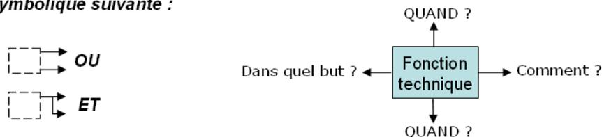
Figure 17 : Structure d'un diagramme FAST selon Brissard et al. [2003]
