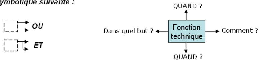
Figure 17 : Structure d'un diagramme FAST selon Brissard et al. [2003]
