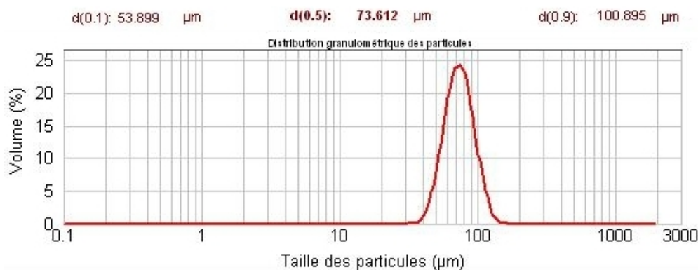
FIG. III.3 – Distribution en taille et en volume, de la poudre de Ni-Al, obtenue par granulométrie laser (ADA200 MASTERSIZE commercialisée par MALVERN).
