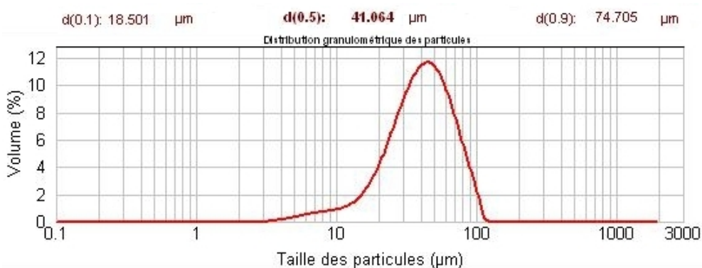
FIG. III.35 – Distribution en taille et en nombre de la poudre de Al6061 obtenue par granulométrie laser (ADA200 MASTERSIZE commercialisé par MALVERN).
