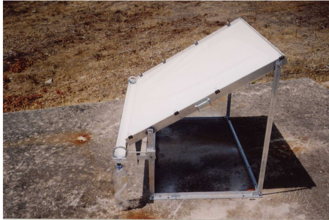
Figure I.4. Condenseur standard 1 m 2 incliné à 30°, installé au laboratoire de l'UDC en 2003
