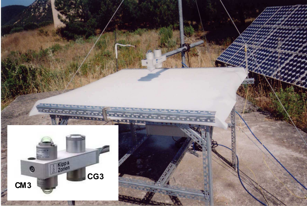
Figure I.17. Banc expérimental de mesure des radiances visibles et IR, Laboratoire UDC, financements CEA/UDC (photo : M.Muselli)
