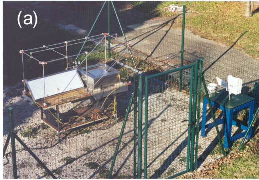
Figure I.25. (a) : Maquette de condenseur 1 \times 0,3 \text{ m}^2 pour l'étude de l'influence de l'angle d'inclinaison d'un plan incliné sur la production en masse d'eau condensée. (b) : dispositif complet : C : maquette, B : balance avec PMMA (Photo : D.Beysens)
