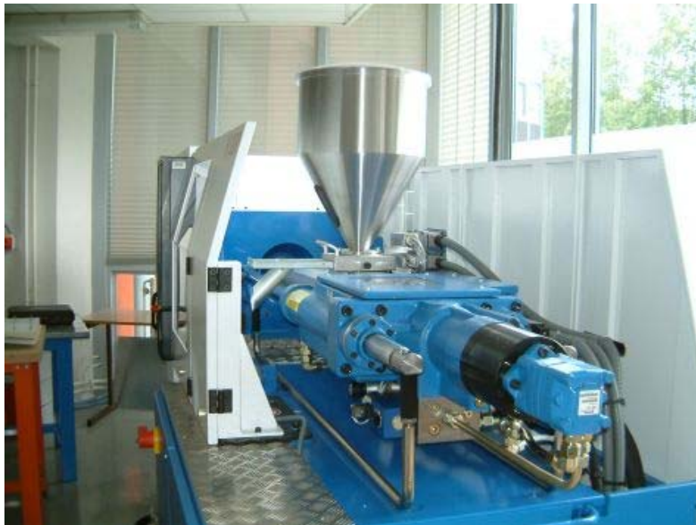
Fig. 2.1.5 - Presse à injection.
