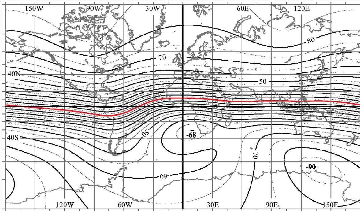
Figure A1.11 : Mappemonde de l'inclinaison magnétique  $I$  (en degrés), d'après l'IPRG, 11<sup>e</sup> méthode (2010).
