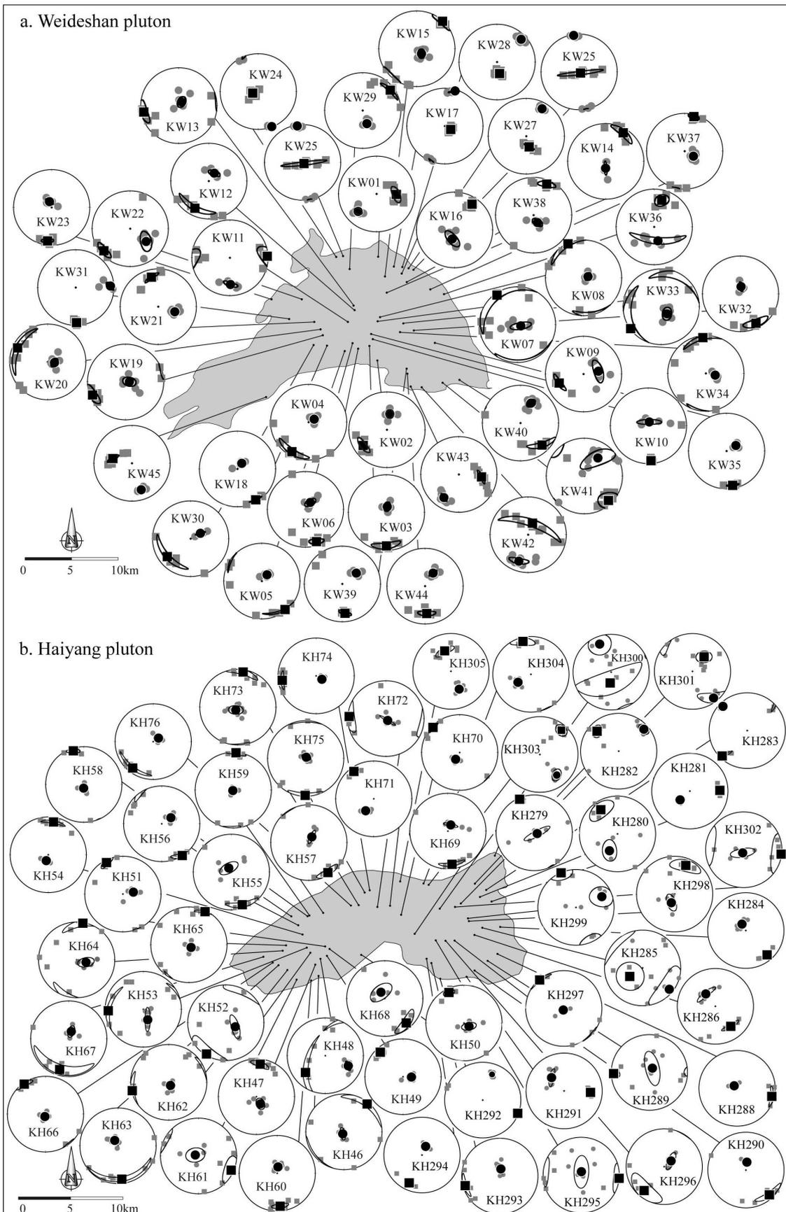
Figure 5.14 : Représentation stéréographiques des directions des axes  $K_1$  et  $K_3$  de l'ellipsoïde de l'ASM pour les plutons de (a) Weideshan et (b) Haiyang ; (c) le dôme extensif du Linglong, le pluton syncinématique de Guojialing, les plutons dits « pinkish-reddish » et (d) le pluton de Luanjiahe.
