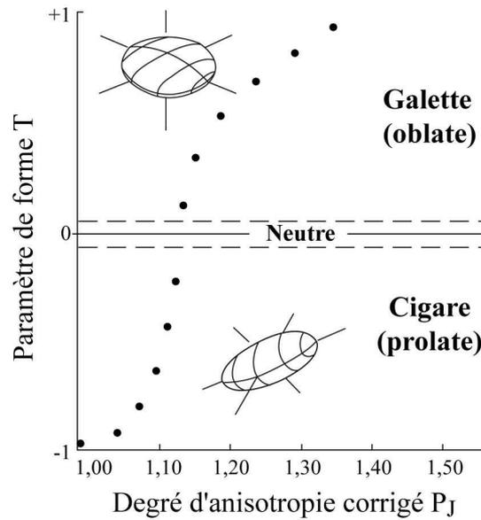
Figure A1.21 : Relation entre le paramètre de forme  $T$  et le degré d'anisotropie corrigé  $P_j$  permettant de définir la forme (galette ou cigare) de l'ellipsoïde de susceptibilité magnétique (modifié d'après Tarling et Hrouda (1993)).
