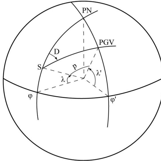
Figure A1.28 : Calcul de la position du PGV. PN = pôle nord géographique, S = site d'échantillonnage,  $\lambda$  et  $\varphi$  sont respectivement la latitude et la longitude du site d'échantillonnage,  $D$  = déclinaison magnétique,  $p$  = colatitude magnétique, PGV = pôle géomagnétique virtuel,  $\lambda'$  et  $\varphi'$  sont respectivement la latitude et la longitude du PGV.
