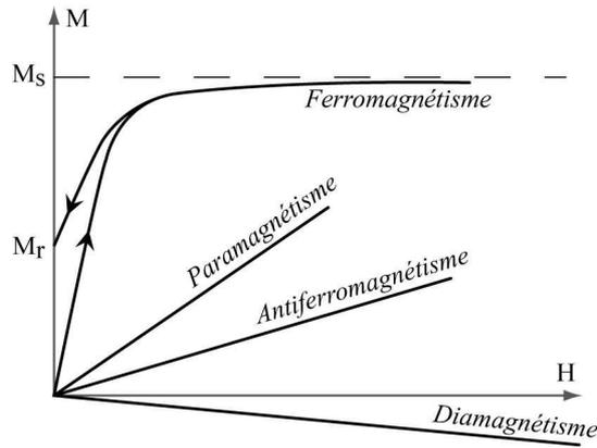
Figure A1.12 : Relation entre l'aimantation  $M$  et le champ magnétique appliqué  $H$  pour les différents comportements magnétiques des solides. Modifié d'après Bouchez (1997).  $M_s$  est l'aimantation à saturation, et  $M_r$  l'aimantation rémanente.
