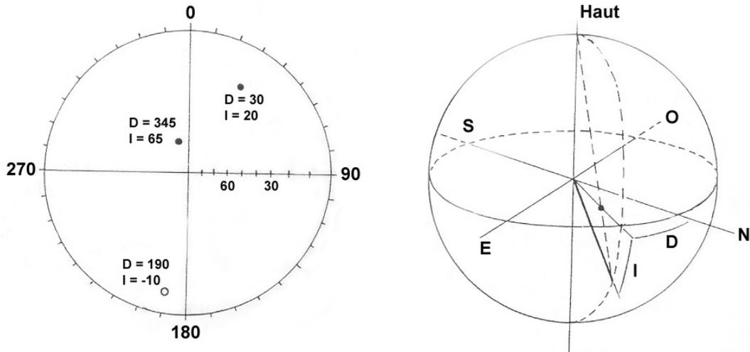
Figure A1.26 : Projection stéréographique de l'extrémité de plusieurs vecteurs aimantation dont la longueur est égale au rayon de la sphère matérialisée à droite.  $D$  = déclinaison magnétique et  $I$  = inclinaison magnétique (en degrés).
