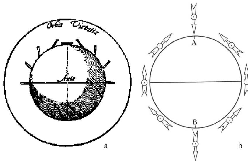
Figure A1.4: Schéma de la Terella (sphère de magnétite) de W. Gilbert. (a) Schéma original de la Terella issu de l'ouvrage « De Magnete » (1600) et (b) schéma montrant les inclinaisons de l'aiguille d'une boussole autour d'une sphère de magnétite, correspondant à celle autour de la Terre (Dunlop et Ozdemir, 1997).
