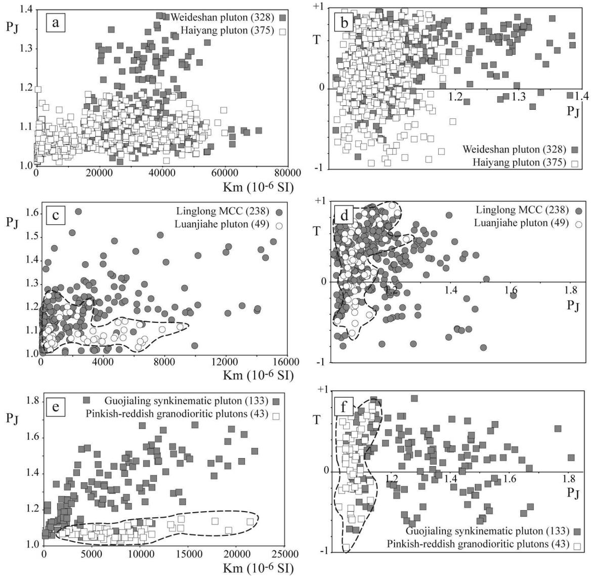
Figure 5.13 : Paramètres de l'ASM. (a, c, e) Degré d'anisotropie corrigé  $P_J$  en fonction de la susceptibilité magnétique volumique  $K_m$ . (b, d, f) Paramètre de forme  $T$  en fonction du degré d'anisotropie corrigé  $P_J$ . Pour les plutons de Weideshan et Haiyang, le dôme extensif du Linglong, le pluton syncinématique de Guojialing, les plutons dits « pinkish-reddish » et celui de Luanjiahe.
