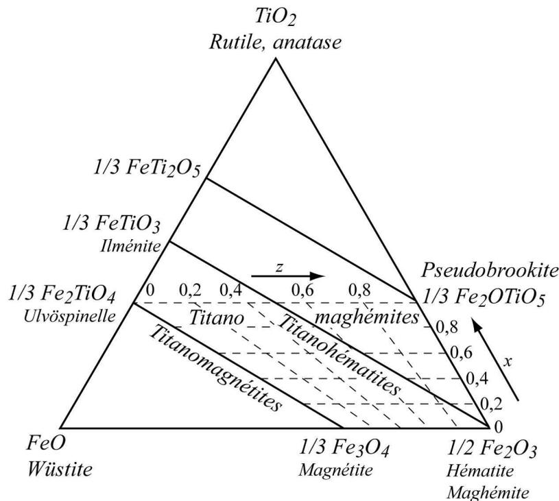
Figure A1.13 : Diagramme ternaire  $TiO_2$ - $FeO$ - $Fe_2O_3$ , montrant les lignes des solutions solides des titanomagnétites et des titanohématites, ainsi que le champ d'existence des titanomaghémites. Modifié d'après Readman et O'Reilly (1972), O'Reilly (1976), et issu de Dunlop et Ozdemir (1997).
