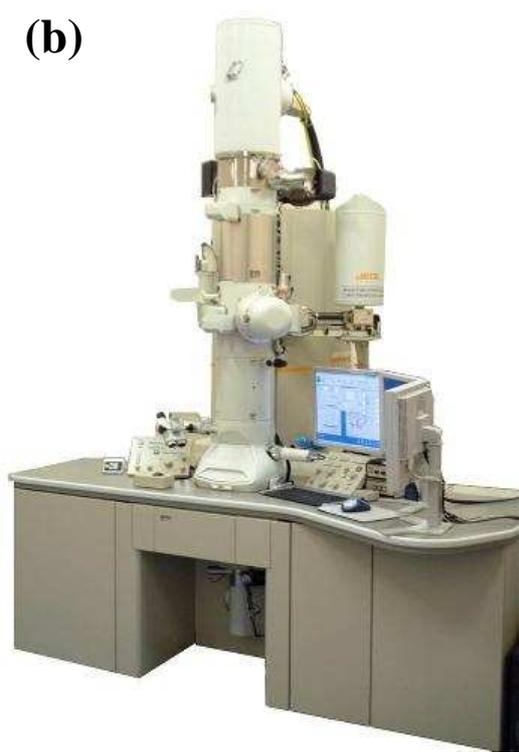
*Fig. II.34 : Microscopes électroniques en transmission utilisés : (a) TOPCON-002B ; (b) JEOL 2100 FCs.*
