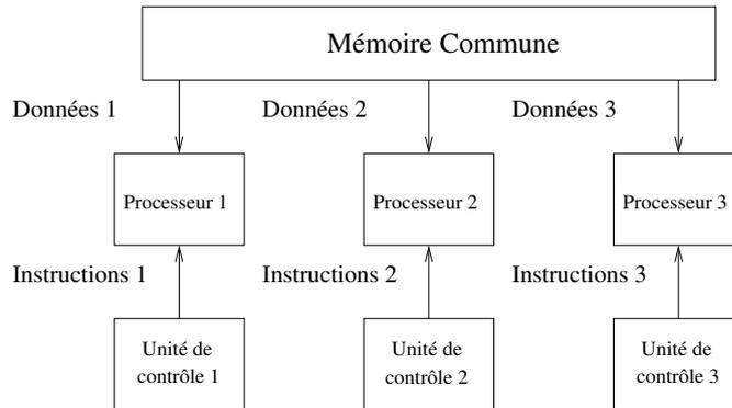
FIGURE 1.7 – Exemple de machine parallèle MIMD.
