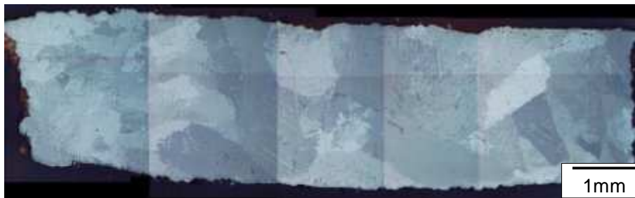
Figure II-20 : Section de l'éprouvette dans la zone utile observée en lumière polarisée
