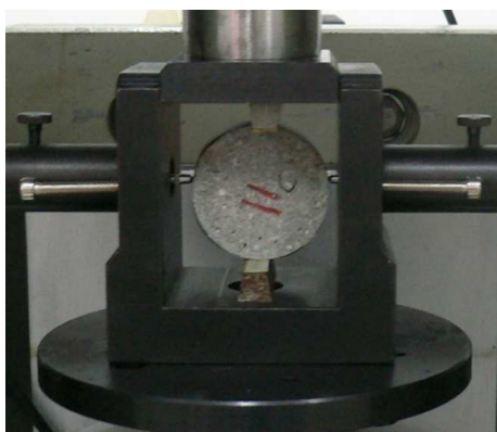
Figure 141. Procédure de test brésilien modifiée [Yu et al. (2009)]
