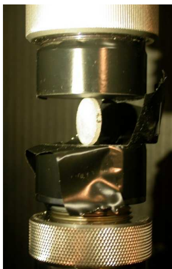
Figure 74. Pastille abradable en position entre les plateaux de compression pour l'essai Brésilien
