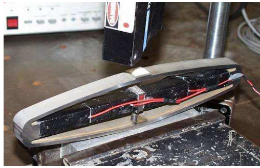
Figure 124. Actionneur APA750XL testé dans le cadre de cette étude
