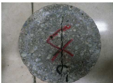
Figure 72. Eprouvette de béton après essai brésilien [Yu et al. (2009)]
