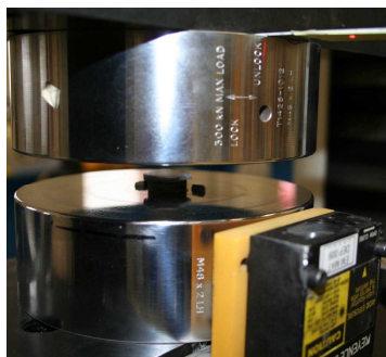
Figure 139. Presse électromécanique pour les essais de compression statique
