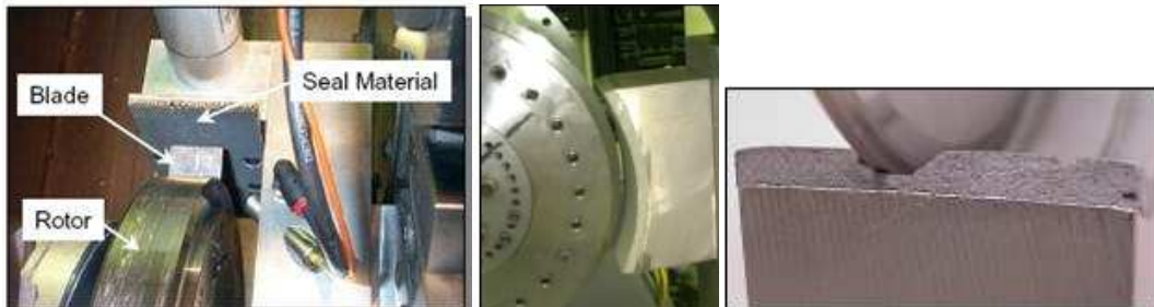
Figure 16. Banc d'abrasabilité basse vitesse TECHNETICS [Chappel (2001)]
