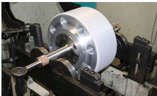
Figure 120. Equilibrage dynamique du tambour sur machine de type SCHENCK
