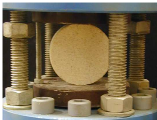
Figure 71. Essai brésilien ou de fendage sur une éprouvette de gypse
