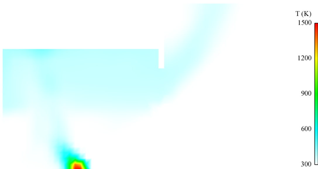
FIG. 6.24 – Champ moyen de la température dans le plan de symétrie pour \dot{Q} = 62.9 \text{ kW} .
