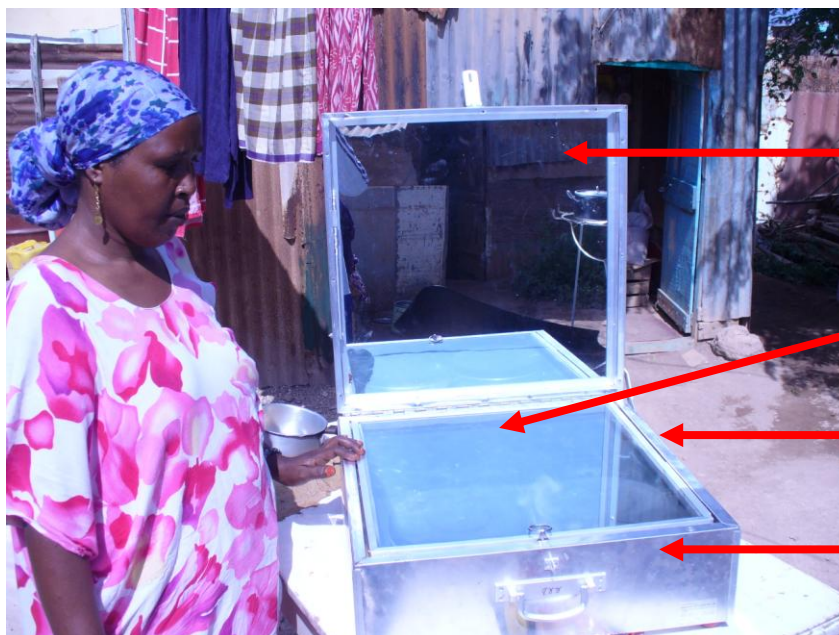
Photo 2.13 : le four solaire en « boîte » modèle indien
