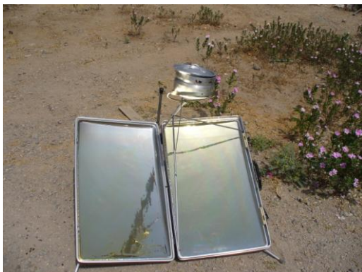
Photo 2.9 : cuiseur parabolique en fonctionnement
