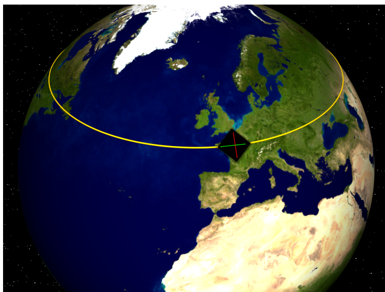
FIGURE 3.6 – Directions d'oscillation du pendule de Foucault initiale (rouge) et direction d'oscillation après un jour (vert) dans le plan tangent à la terre. La trajectoire suivie par le plan tangent est représentée en jaune.
