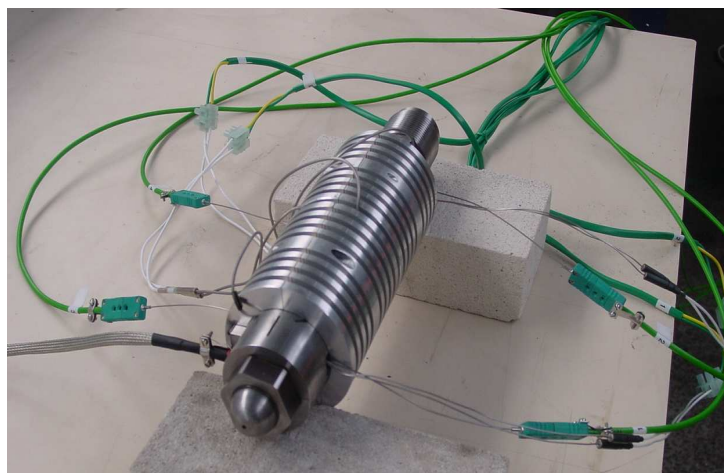
Figure III-28 : Vue de la buse avec l'instrumentation finie
