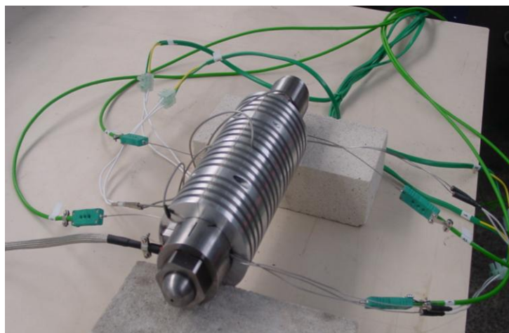
Figure III-28 : Vue de la buse avec l'instrumentation finie
