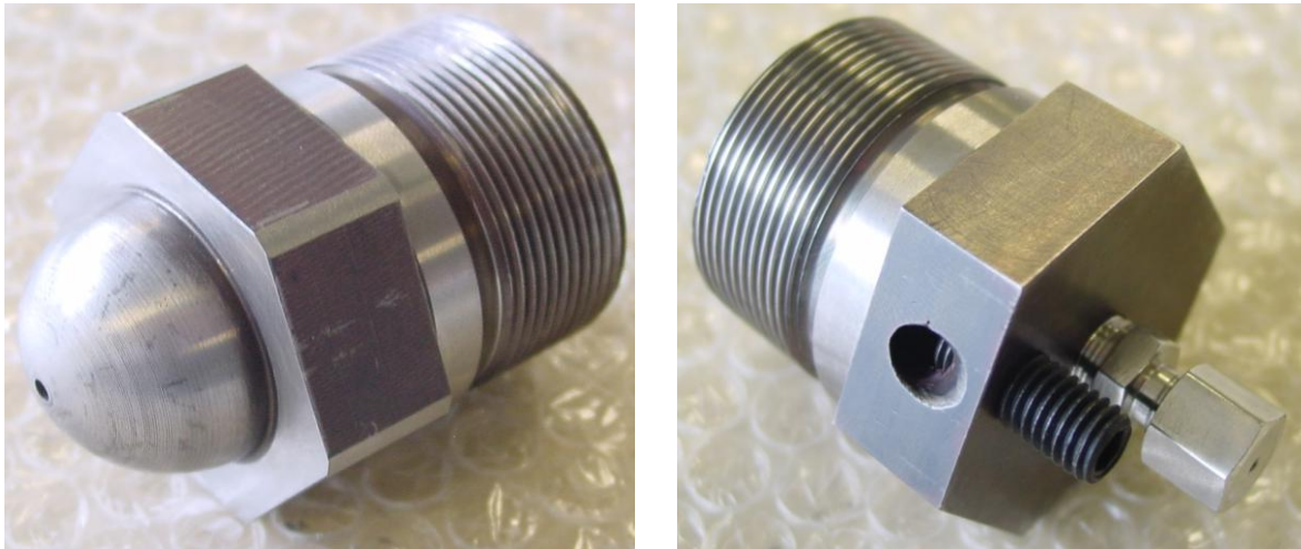
Figure III-9 : a) Nez de buse non instrumenté servant pour l'injection et b) instrumenté avec un thermocouple
