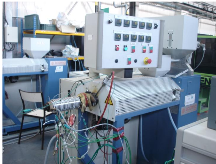
Figure IV-12 : Photo d'une extrudeuse de l'IUT de Nantes
