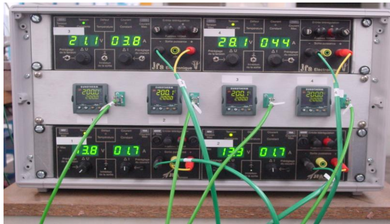
Figure III-13 : Alimentations des quatre zones de chauffe
