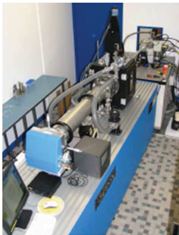
Figure A.9 – Photographie de l'équipement de diffusion centrale du LPEC (Université du Maine)
