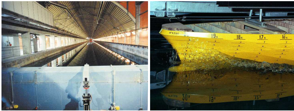
FIGURE 1 – Bassin de traction B600 du Bassin d’Essais des Carènes de Val de Reuil (gauche) et essai de résistance sur un modèle réduit dans le même bassin. (Photos : Bassin d’Essais des Carènes)
