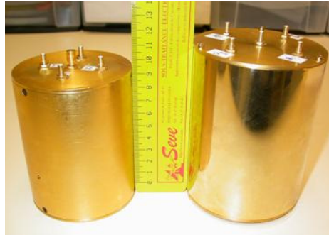
Fig.21 : Photographie d'une résistance calculable à couche mince dans son boîtier de mesure
