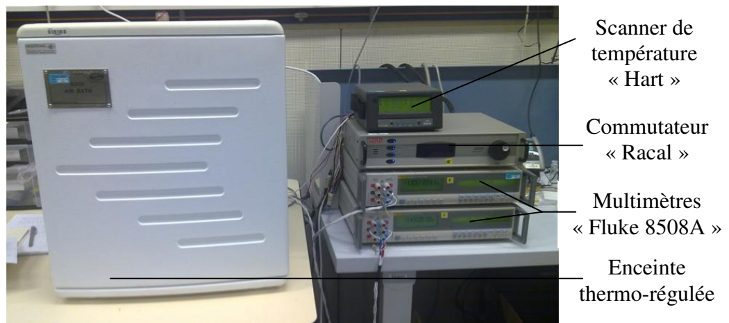
Fig.48 : Banc automatique de mesure de résistances
