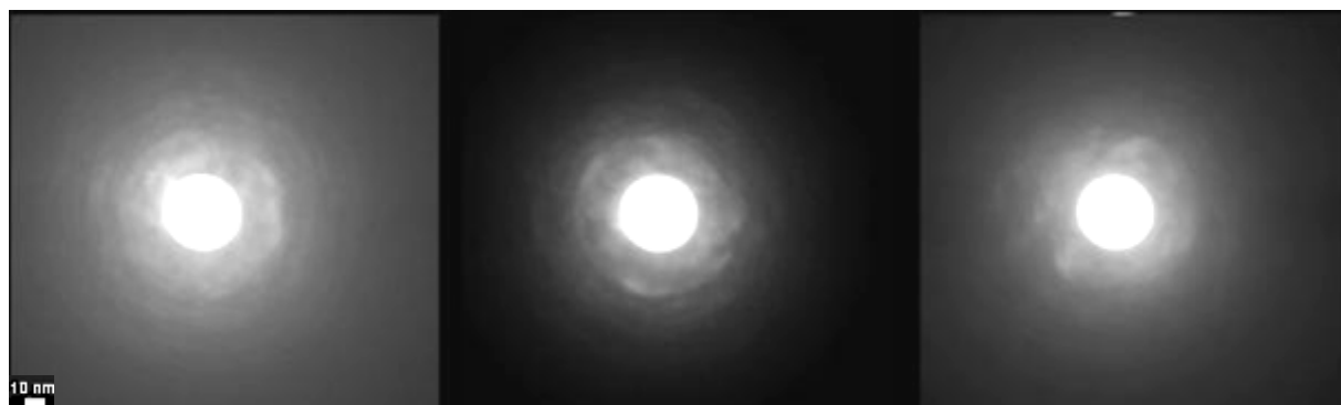
Fig.87 : Clichés de diffraction CBED de la couche ultra-mince métallique
