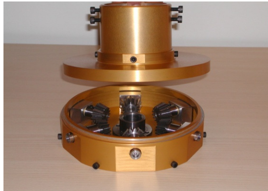
Fig.34 : Photographie du porte-échantillons rotatif pour le bâti Alcatel SCM 450
