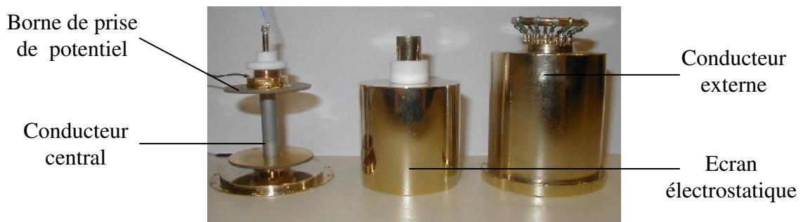
Fig.19 : Photographie des éléments constitutifs de la résistance à couche mince
