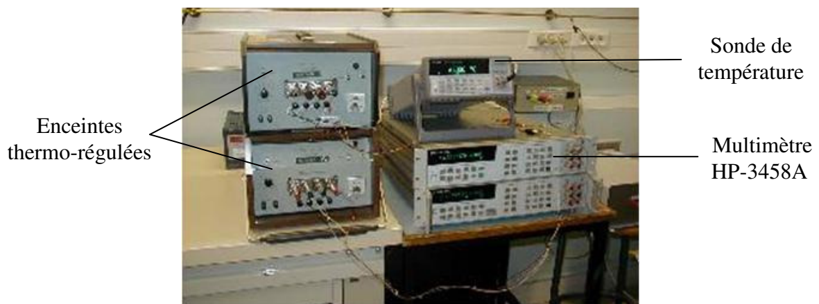
Fig.23 : Photographie du banc de mesure des résistances en courant continu
