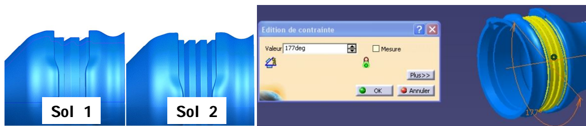
Fig. 129. Choix des embouts pour répondre à une exigence en effort de montage.
