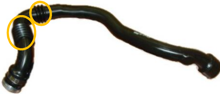
Fig. 100. Soufflets sur un conduit d'air RAS / BP
