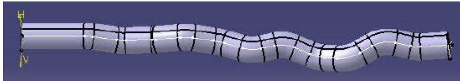
Fig. 57. Modélisation du corps du conduit par opération de nervure.
