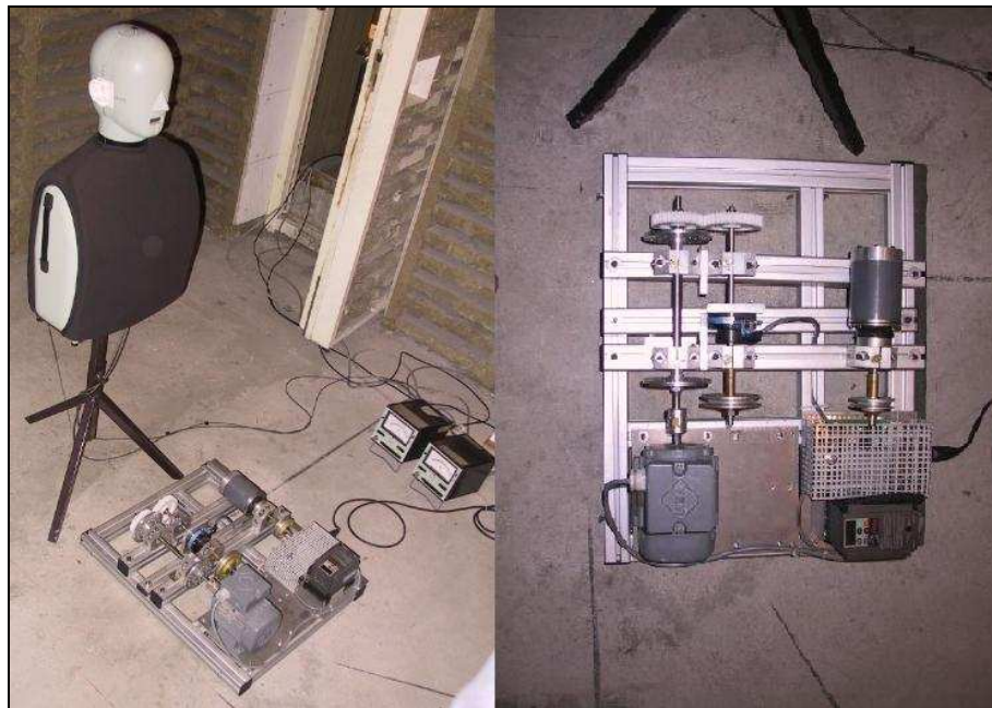
FIG. 3.3 – Mannequin acoustique placé en position d'enregistrement au-dessus du banc d'essai, configuré selon la matrice d'expérience (tableau 3.3).
