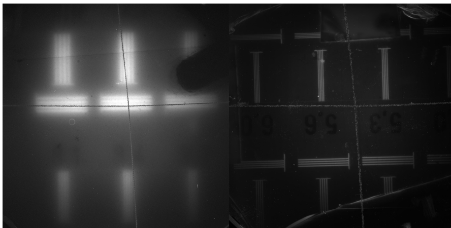
Figure 54 : Images d'une alumine chromée (gauche) et d'un YAG:Ce (droite) sous X à 40 keV
