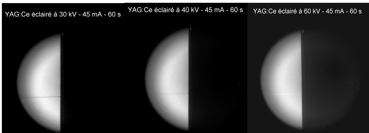
Figure 82 : Images de bord franc sur YAG:Cérium
