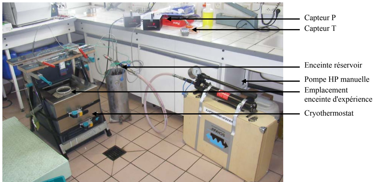
Figure III.7 : Vue générale du dispositif miniaturisé à compression indirecte et vitesse d'application rapide
