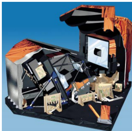
Figure 18. Vue d'artiste de l'instrument GOMOS et de ses composants (Ratier et al., 1999).
