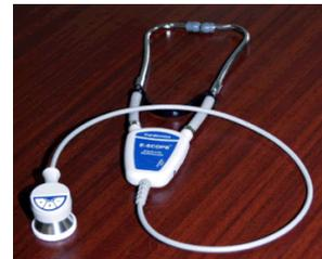
La personne désirant écouter les sons utilise un casque infrarouge. Le système dispose de 8 filtres qui permettent l'atténuation ou l'augmentation de 8 différentes bandes de fréquences (pour par exemple accentuer le murmure).
