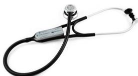
Le médecin peut enregistrer les sons via iPod pour une analyse ultérieure. L'analyse (représentation temporelle et spectrale) se fait à l'aide d'une version personnalisée du logiciel libre *Audacity*.
