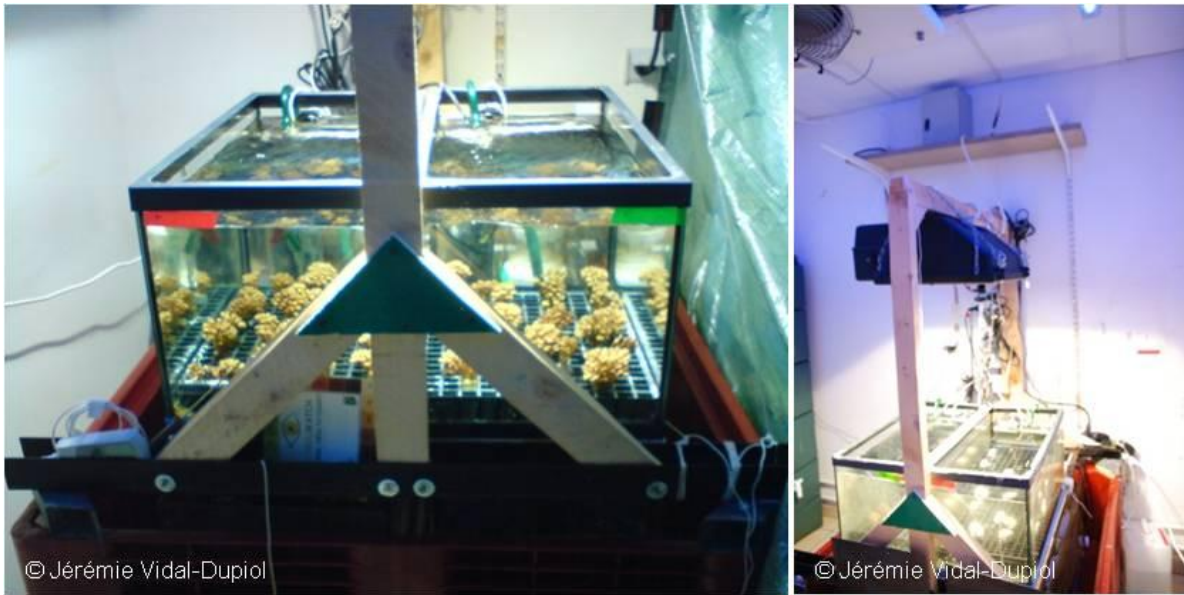
Figure 24 : structures expérimentales dédiées à l'étude des stress biotiques sur la physiologie des coraux : Compte tenu des risques de contaminations par V. coralliilyticus lors des étapes de stress biotiques, des structures expérimentales ont été spécialement mises au point pour réaliser les expériences au BETM (pour la partie avec bactéries). Les contrôles sans bactéries ont été réalisés dans les mêmes structures à l'Aquarium du Cap d'Agde.
