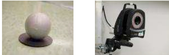
Marqueur réfléchissant (d=10mm) Caméra et éclairage infra-rouge
