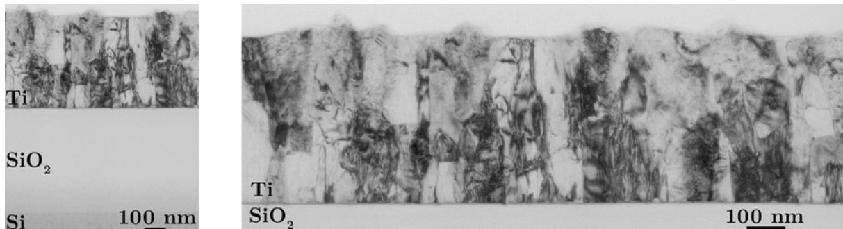
FIGURE 2.38 – Cliché TEM en fond clair du dépôt Ti 450 nm sur \text{SiO}_2 thermique après traitement thermique en ampoule sous 0.2 mbar de \text{N}_2
