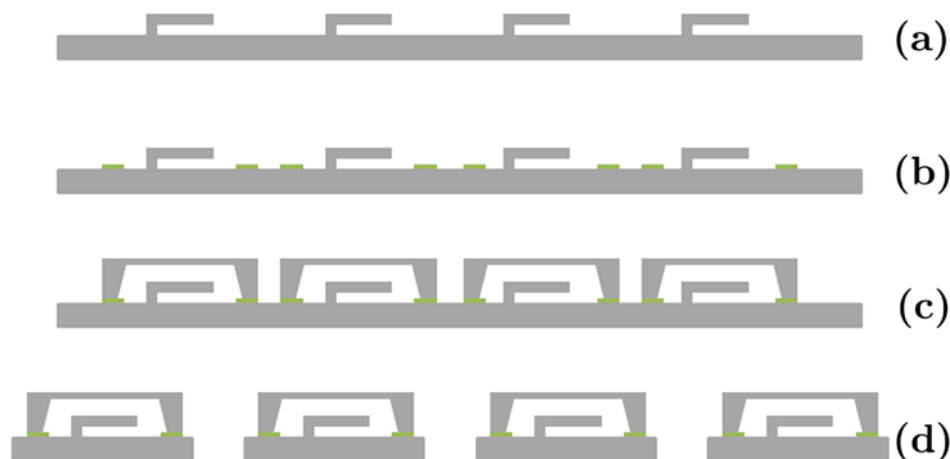
FIGURE 1.8 – Principe du chip scale packaging : dispositifs micro-usinés sur le wafer (a), élaboration des anneaux de scellement (b), report des capots individuels (c), et découpe du wafer (d)
