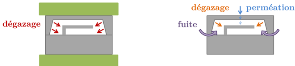
FIGURE 1.14 – Sources de gaz dans les MEMS : au scellement (gauche) et durant l'utilisation du dispositif (droite)
