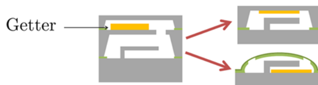
FIGURE 1.18 – Intégration des getters dans les MEMS : Wafer-Level Packaging
