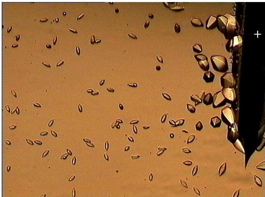
**Figure 51** : Photo d'une solution de BPTI à 20mg/mL dans un tampon acétate de 80mM, pH = 4,5 et 1,6M de NaCl. Application d'une tension directe de 0, 785V. Le fil de tungstène a une largeur de 125µm.
