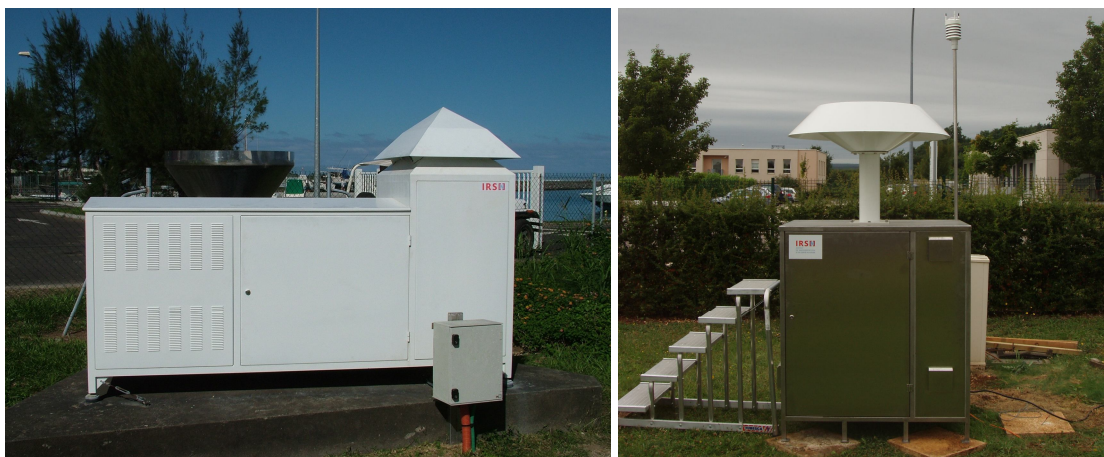
Figure 1-3 : Collecteurs d'ancienne génération (gauche) et de nouvelle génération TGD (droite).
