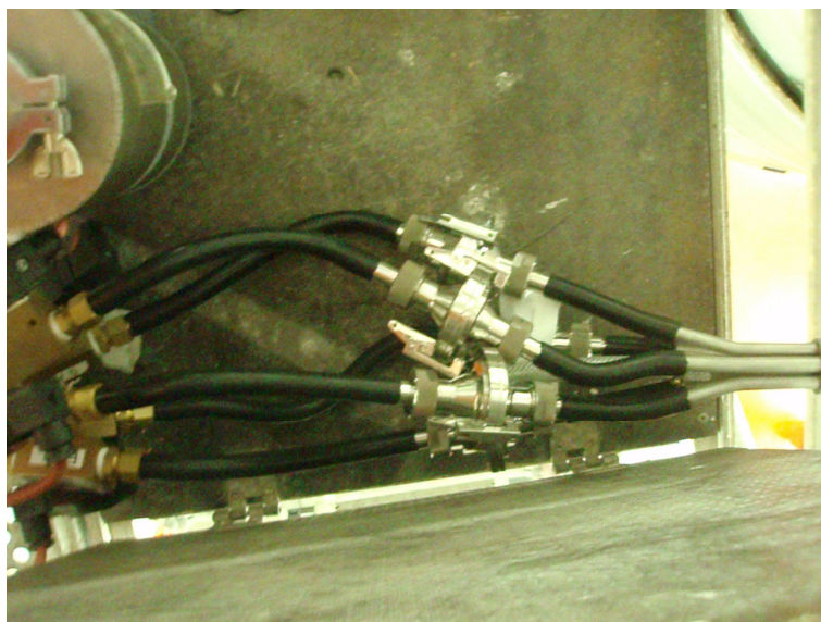
Figure 5.5 : Batterie de filtres utilisée pour la détermination par spectrométrie gamma des radionucléides émis par la combustion du bois.
