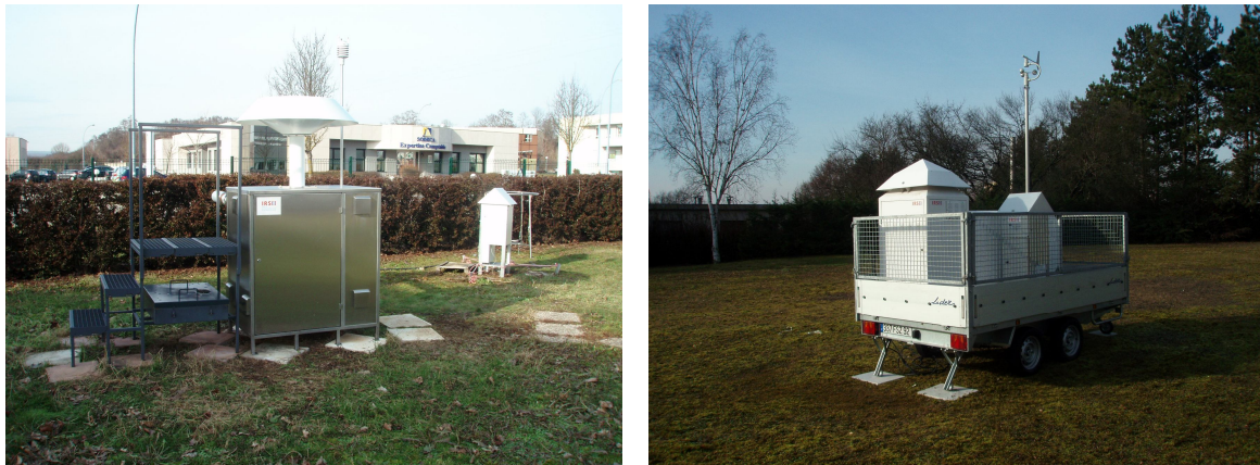
Figure 5.25 : Station OPERA TGD et cabine Hi-Vol sur le site de référence au nord de l'agglomération dijonnaise (gauche) et remorque intégrant la station d'ancienne génération du réseau OPERA et la cabine Hi-Vol (droite).
