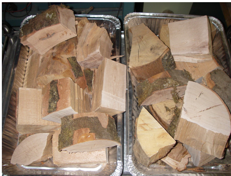
Figure 5.2 : Photographie du conditionnement des morceaux de bois utilisés lors de la simulation de la combustion de bois dans une cheminée domestique.
