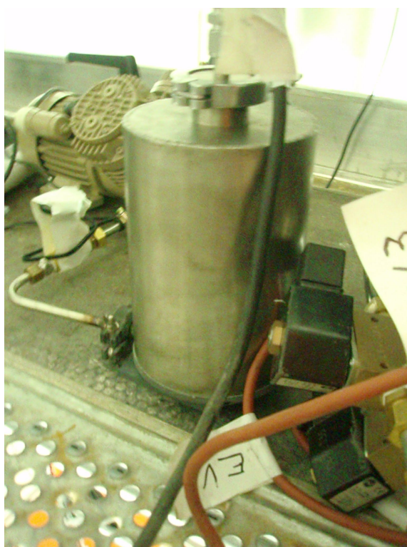
Figure 5.6 : Impacteur Andersen (gauche) et équipement de la balance TEOM (droite) utilisés pour la caractérisation des aérosols émis lors de la combustion du bois.
