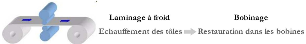
**Figure I-3 : Problématique de la restauration de tôles laminées à froid.**
