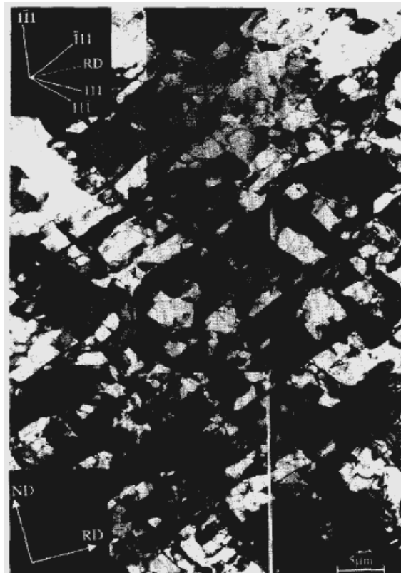
Figure II-7 : Observation MET d'une section longitudinale d'un monocristal d'orientation Laiton, déformé à froid ( \epsilon=0,5 ). Les traces des plans \{111\} sont indiquées. [Godfrey et al. 1998]
