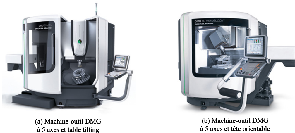
Figure 1-10 : Architecture de machine-outil à table tilting et à tête orientable
