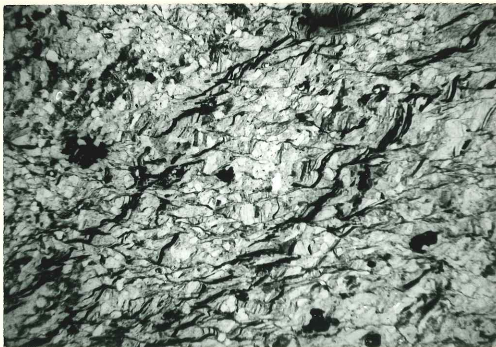
PHOTO 21. Microfaciès 2: Grès micacé rouge lie-de-vin (Stéphanien supérieur, Malatrait) . Les deux alignements de micas détritiques, reconnaissables par les trainées d'hydroxydes de fer fixés sur les plans de clivage, sont cisailés par la schistosité horizontale. Celle-ci tend à réorienter les micas selon un plan vertical (au centre). (L.N. X40.)
