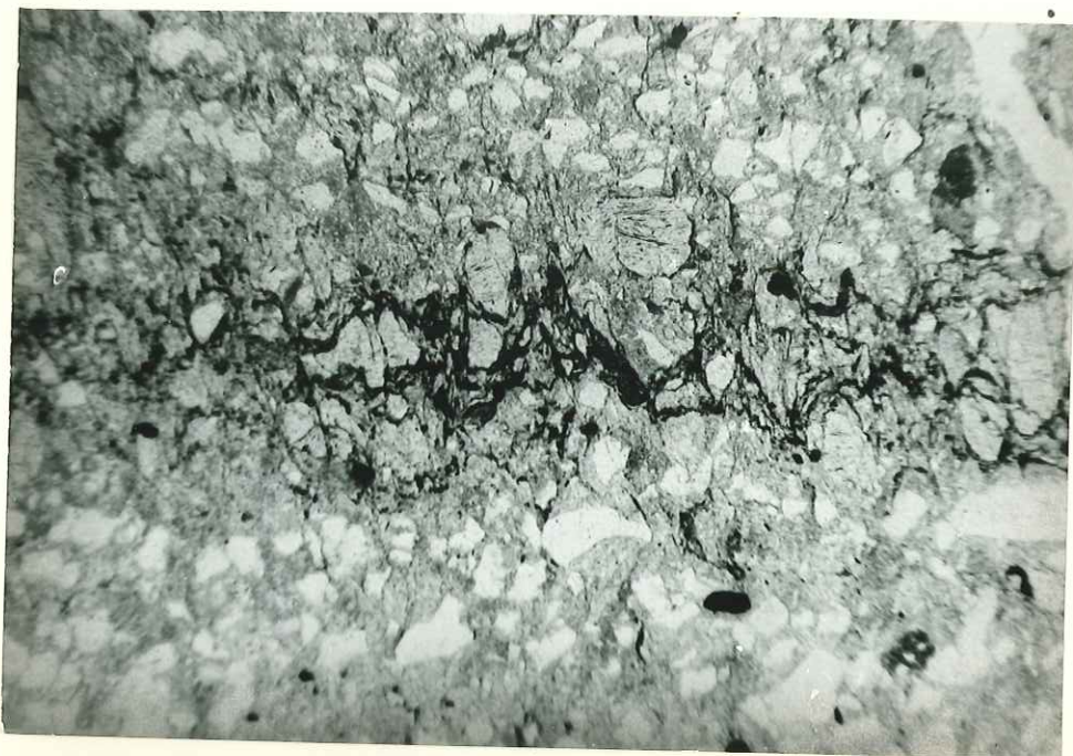
PHOTO 37. Limets carbonneux déformés par la schistosité, prenant l'allure de joint stylolithique. (L.N. X 100)
