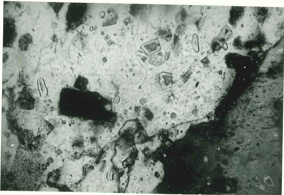
PHOTO 28 bis. Silicification des calcaires-dolomitiques du Trias. Fragment de quartz secondaire montrant de nombreuses inclusions solides d'anhydrite et de dolomite. (X 250)
