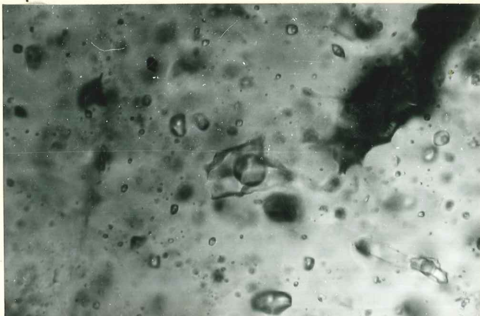
PHOTO 19. La même inclusion, au cours d'un échauffement d'une dizaine de degrés C. L'homogénéisation du constituant volatil s'est effectué en phase liquide, par disparition de la phase gazeuse.
