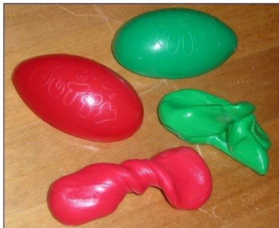
Figure 7 : Un exemple de fluide viscoélastique : la pâte de « silly-putty ».
