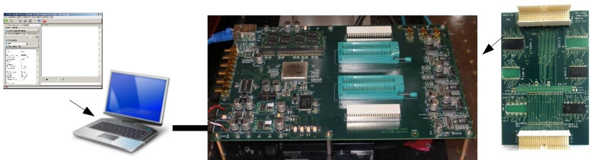
Figure IV-2 : Testeur ELECTRE utilisé pour le test de DRAMs au laser et en accélérateur de particules
