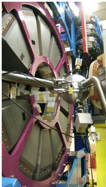
FIG. 2.7 – A gauche, vue du multidétecteur CLARA avec la chambre à réaction. A droite, plan des positions de l'ensemble des détecteurs composant le multidétecteur CLARA. Les détecteurs 1 à 12 sont placés à 102^\circ , les détecteurs 13, 18, 17, 21 sont à 128^\circ , les détecteurs 22, 23, 24, 25 sont à 134^\circ , les détecteurs 14, 16, 19, 20 sont à 154^\circ , et enfin le détecteur 15 se place à 180^\circ .
