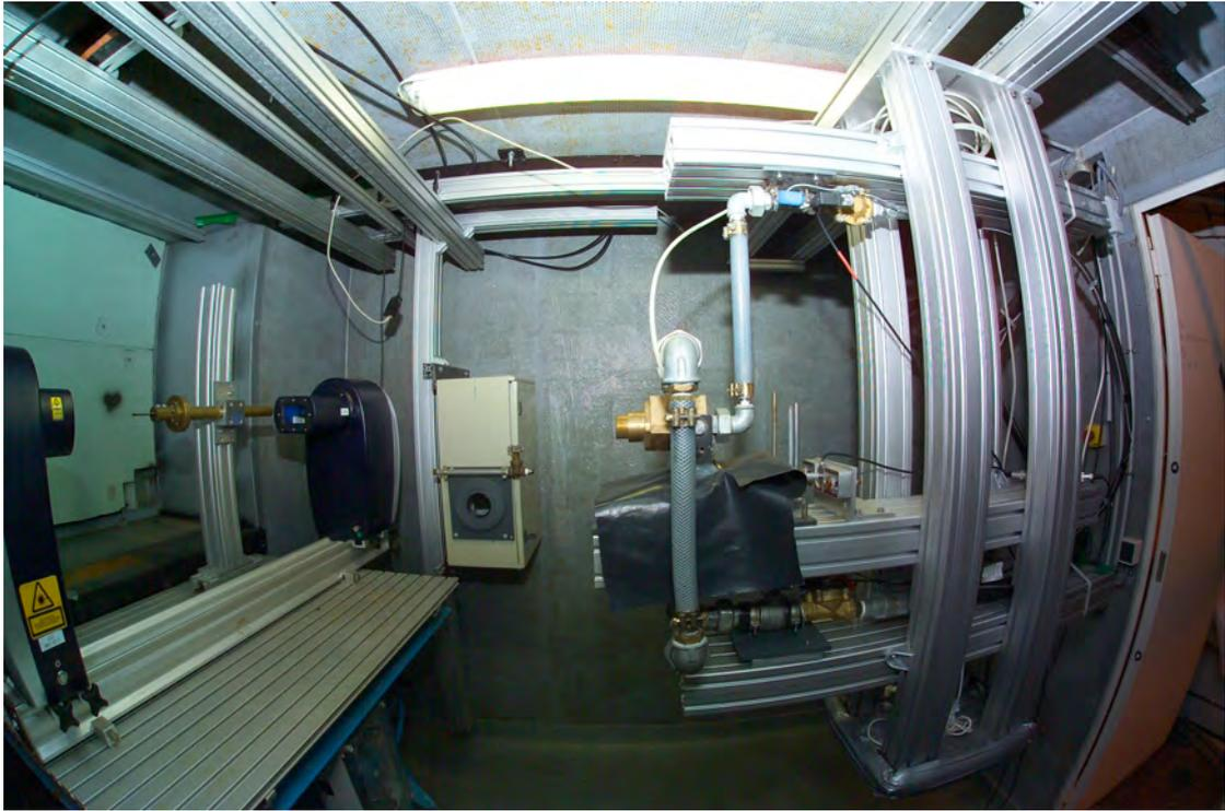
FIGURE 4.2 – Photos (grand angle [déformation de l'image]) de l'intérieur du caisson insonorisé. A droite la tuyère et son support réglable. A gauche, la table supportant l'instrumentation pour la caractérisation du jet (ici le granulomètre à diffraction laser et support de la sonde optique). En arrière plan le boîtier étanche de l'appareil photo.
