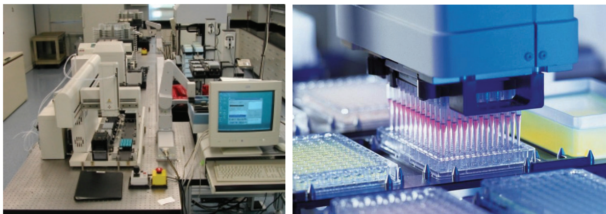
FIG. 7 - Aperçu d'une plateforme de criblage haut-débit robotisé et d'une plaque à 96 puits.
