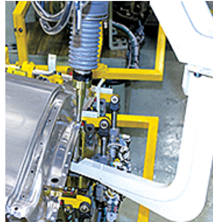
Figure 1.14 – Soudage de capot de voiture (Mazda)
