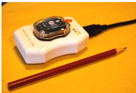
Seconde version : capteur, recharge par fixation, dock de recharge et de réception des signaux
