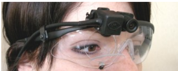
Mobile Eye, lunettes et caméras : une vidéo filme la scène qui se déroule en face du sujet. La seconde caméra filme le reflet de l'œil dans la lentille articulée.
