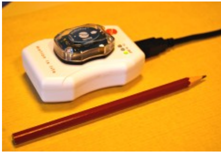
Seconde version : capteur, recharge par fixation, dock de recharge et de réception des signaux
