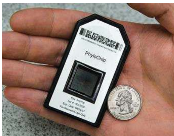
Figure I-2 : Exemple de laboratoire sur puce fabriqué à Berkeley permettant l'analyse rapide de populations microbiennes. Image issue du site ( http://www.lbl.gov/publicinfo/newscenter/pr/2008/TT-RD100.html ).
