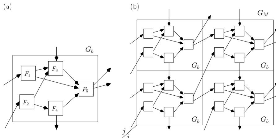
FIG. 3.4 – Deux niveaux d’abstraction de graphe : au niveau le plus bas (a), on construit le graphe dans un point de grille  $G_b$ . Au niveau spatial (b), le même graphe  $G_b$  est répliqué pour chaque point de grille, formant ainsi le graphe de l’espace  $G_M$  (en 2D dans cet exemple). Les connexions spatiales entre graphe  $G_b$  correspondent aux *connexions de base* entre modules appartenant à deux points de grille différents.
