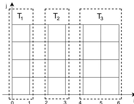
FIG. 6.4 – Décomposition de domaine d'un espace de calcul de dimensions 5x7 avec 3 *threads*  $T_1$ . La décomposition est faite en partitionnant l'axe  $i$  en trois sous-intervalles ( $[0,1]$ ,  $[2,3]$ ,  $[4,6]$ ). Les *threads*  $T_1$ ,  $T_2$ ,  $T_3$  sont associés aux trois sous-domaines obtenus.
