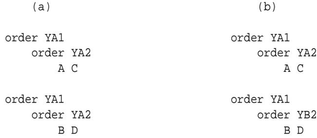
FIG. 4.2 – (a) cohérence et (b) incohérence des directives *order* pour le graphe modulaire de la figure 4.1. La connexion incohérente relative aux *order* imbriqués est  $B(i, j - 1, t) \rightarrow D(i, j, t)$ .
