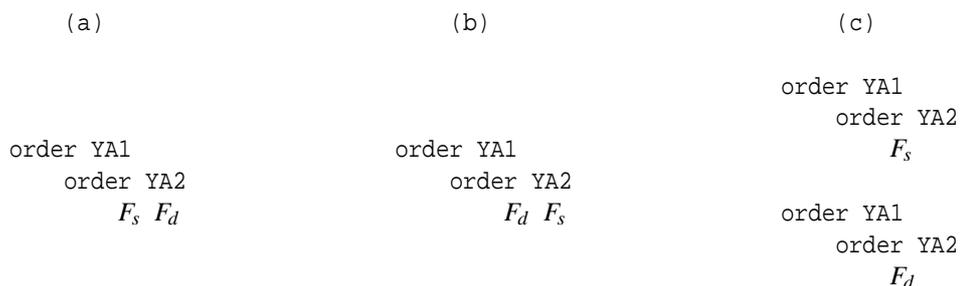
FIG. 4.9 – Directives *order* cohérentes par rapport à la connexion de la figure 4.8a. Le fait d’avoir la référence relative  $j - 1$  rend correctes les deux solutions (a) et (b). (c) est correct grâce à l’application de la règle 1.
