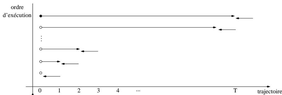
FIG. A.4 – RA : sur l'axe horizontal, il y a les pas de temps de la trajectoire et sur l'axe vertical l'ordre d'exécution des procédures *forward* et *backward* (les *forward* de gauche à droite et les *backward* de droite à gauche). Chaque procédure *backward* au pas de temps  $t$  suit le recalcul préalable de toutes les procédures *forward* des pas de temps précédents.
