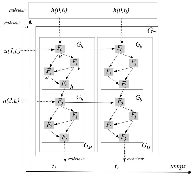
FIG. 3.6 – Graphe modulaire découlant des équations (3.1). Pour un point de grille :  $F_0$  est la *fonction de base d'entrée*,  $F_1$  et  $F_2$  sont les *fonctions de base internes*,  $F_3$  est la *fonction de base de sortie*. Calculer, en un temps  $t_i$ , tous les modules selon leur ordre dans le graphe correspond au calcul de  $M_i(\mathbf{x}(t_0))$ .
