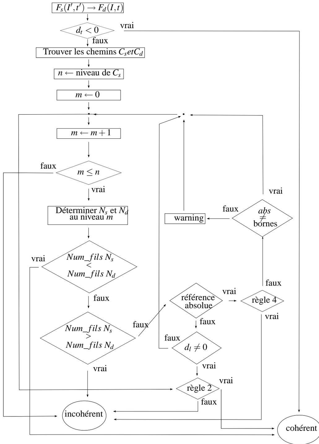
FIG. 4.10 – Organigramme de programmation de l’algorithme de vérification de la cohérence des directives *order*. Ceci est le cas le plus général applicable à toutes sortes de connexions *ctin* (avec références relatives, absolues ou un mélange des deux).
