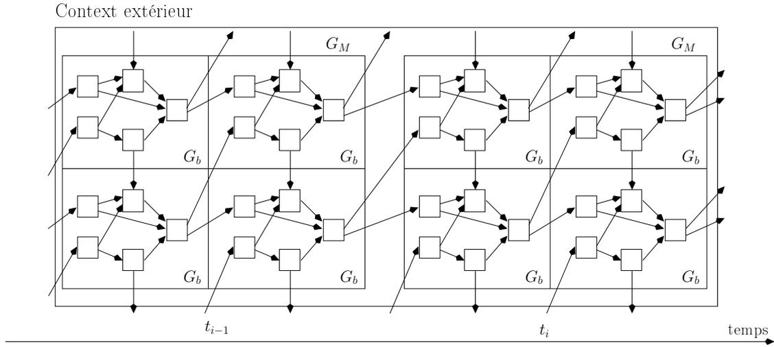
FIG. 3.5 – Le graphe modulaire composé par les  $G_M$ , qui est la répétition de  $G_b$  dans l'espace et dans le temps. Dans cet exemple spécifique, on a une fenêtre temporelle de deux pas de temps ( $t_{i-1}$  and  $t_i$ ).
