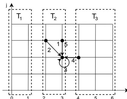
FIG. 6.5 – Décomposition de domaine selon l’axe  $i$  en trois sous-espaces, chacun affecté à un *thread*. On visualise la synchronisation pour le point  $i, j$ . Les numéros sur les flèches sont les mêmes que ceux des arcs de la figure 6.2.
