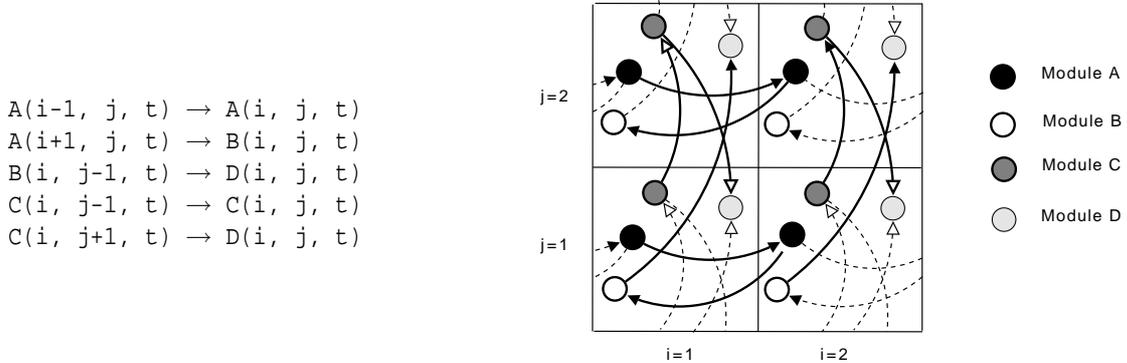
FIG. 4.1 – Graphe modulaire 2D (grille  $2 \times 2$ ) avec 4 *fonctions de base* (A, B, C et D) et 5 connexions. Les flèches en pointillés représentent les connexions qui viennent de et qui vont vers l'extérieur de la grille.
