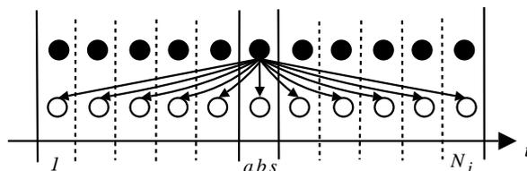
FIG. 4.11 – Connexion  $F_s(abs_i) \rightarrow F_d(i)$  entre deux *fonctions de base* rattachées à deux espaces 1D avec une référence absolue  $abs_i$ . Les cercles en noir et blanc représentent respectivement les modules source et destination. La valeur de la référence absolue est  $abs_i = abs$  avec  $1 < abs < N_i$ .
