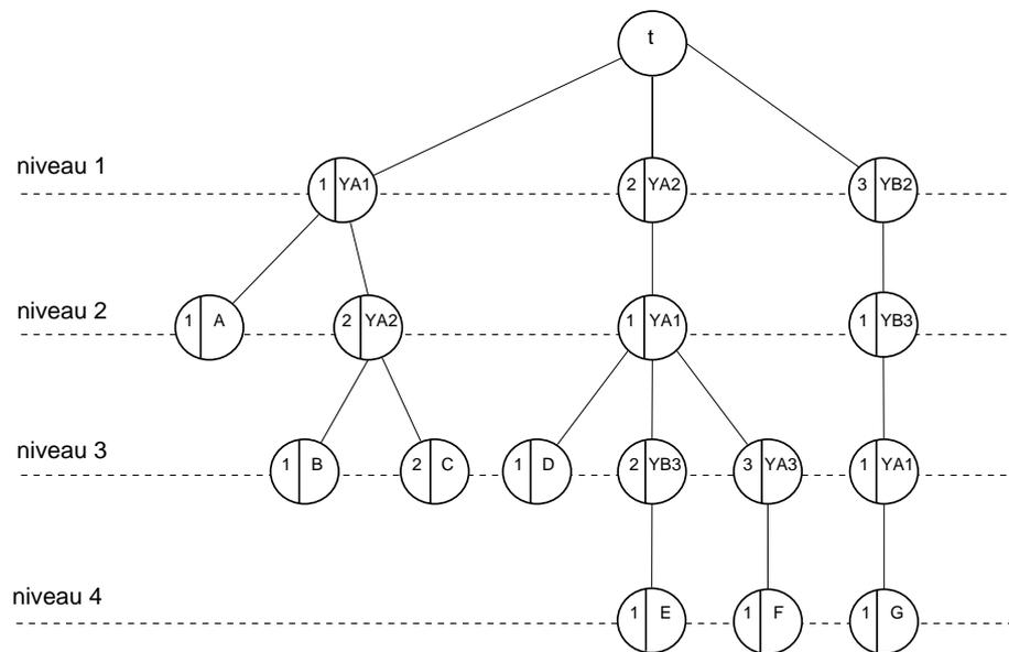
FIG. 4.5 – Cette arborescence correspond aux directives *order* de la figure 4.4. Les feuilles représentent les *fonctions de base* et tous les autres nœuds (les nœuds internes) représentent les boucles, ils sont caractérisés par leurs paramètres  $YXl$ . Tous les nœuds, sauf la racine, se caractérisent par  $num\_fils$ .
