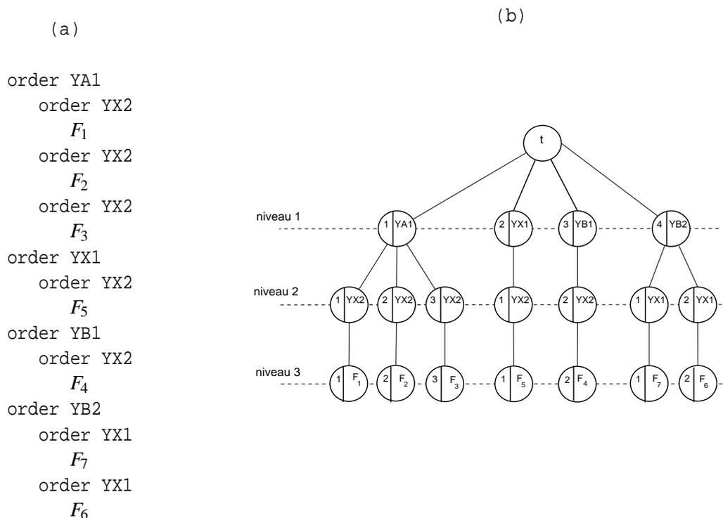
FIG. 5.12 – Génération des directives *order* relatives au *GDR* de figure 5.10. En (a) on a les directives *order* et en (b) l'arbre *arb* des directives générées.
