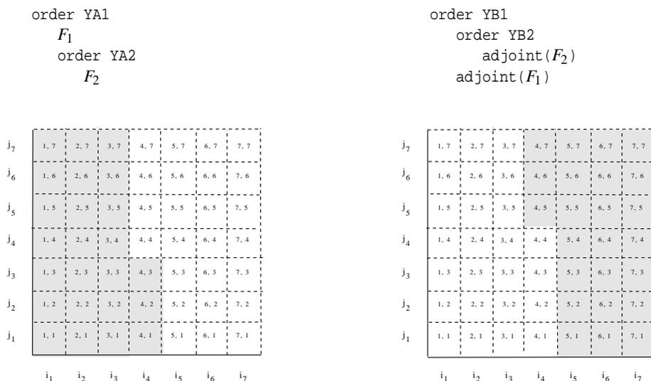
FIG. 6.13 – Exemple de directives *order* et son inversion. La fonction de base  $F_1$  est rattachée à un espace 1D et la fonction  $F_2$  à un espace 2D. Les deux parcours (en foncé) sur la grille de calcul montrent l’inversion par rapport à l’espace 2D propre à  $F_2$  mais également, en prenant une ligne quelconque de la grille, l’inversion par rapport à l’espace 1D.
