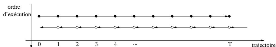
FIG. A.3 – SA : sur l'axe horizontal il y a les pas de temps de la trajectoire et sur l'axe vertical l'ordre d'exécution des procédures *forward* et *backward*. Avec les points noirs et blancs, nous représentons le stockage et la récupération des informations.
