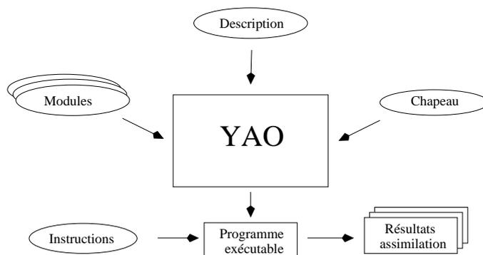
FIG. 3.8 – Représentation schématique de YAO. La génération de code commence à partir du fichier *description*, qui représente la spécification du modèle, et les fichiers *module*. Le code généré, le fichier exécutable, s'exécute par le biais d'un fichier *instructions*, qui permet de contrôler la production des résultats. Le fichier *chapeau* permet d'intégrer au code généré certains points d'entrée d'utilisateur, par la définition des fonctions utilisateur.
