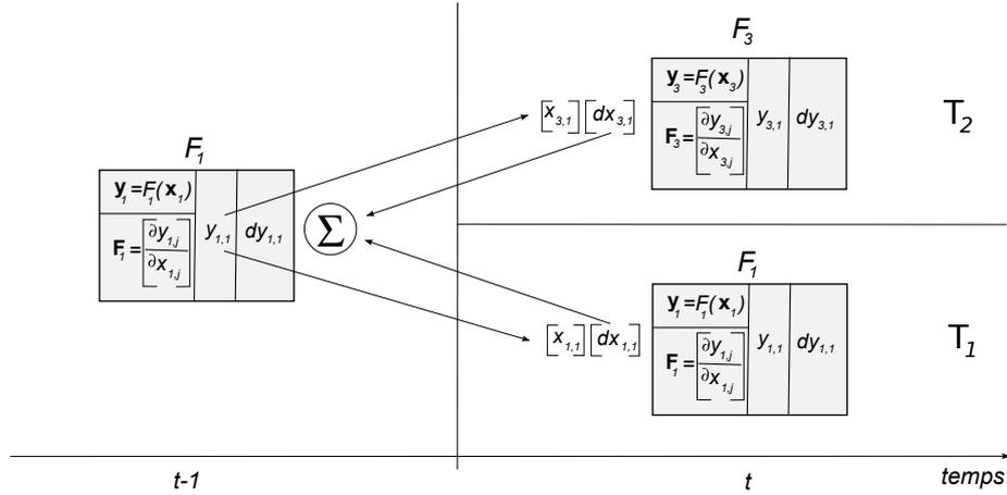
FIG. 6.15 – *Race condition* sur deux mises à jour dans la procédure *backward* de l'exemple 6.14. Les deux connexions représentent un transfert de données entre deux pas de temps  $t$  et  $t - 1$ , par les *threads*  $T_1$  et  $T_2$ , du module  $F_1$  vers  $F_1$  et  $F_3$  dans la phase de propagation. C'est dans la phase de rétropropagation que la *race condition* fait son apparition.
