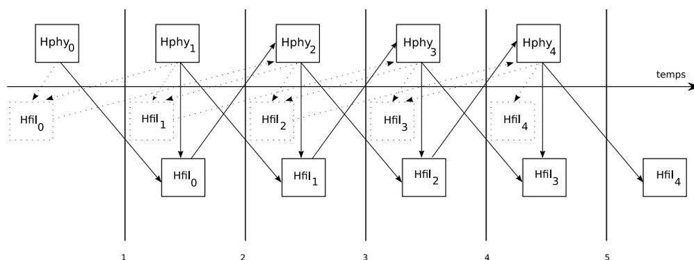
FIG. 3.10 – Décalage de la fonction  $Hfil$  d'un pas de temps sur la fenêtre temporelle. En pointillés, la figure montre la fonction  $Hfil$  au pas de temps original, en indice nous avons noté le pas de temps. Le même décalage concerne les fonctions  $Ufil$  et  $Vfil$ .
