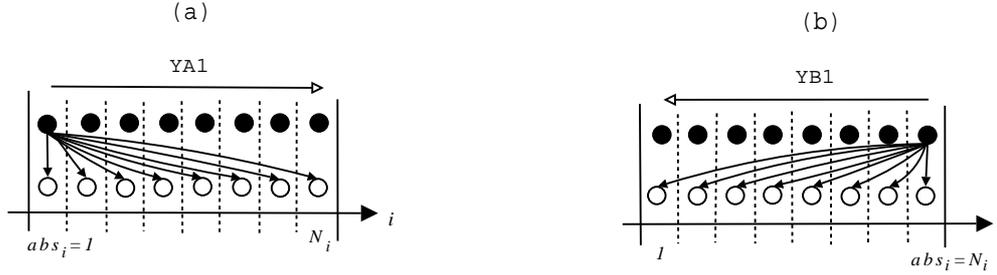
FIG. 4.7 – Connexion  $F_s(abs_i) \rightarrow F_d(I)$  entre deux *fonctions de base* rattachées à deux espaces 1D avec une référence absolue  $abs_i$ . Les cercles en noir et blanc représentent respectivement les modules source et destination. (a)  $abs_i = 1$  et (b)  $abs_i = N_i$ .
